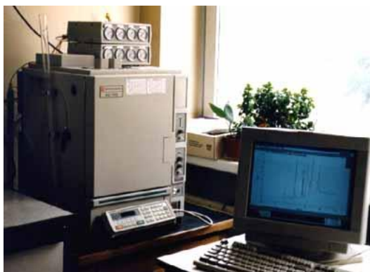
ภาพที่ 3.3 Gas Chromatography (GC - TCD) รุ่น GC – 14B
