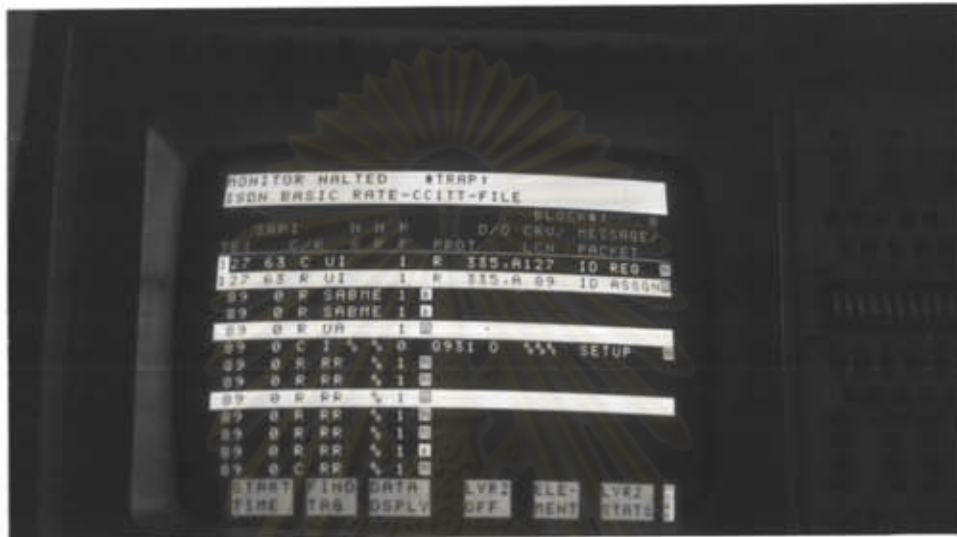
รูปที่ 6.6 แสดงข้อมูลที่รับส่งที่จุดอ้างอิง S ระหว่างอุปกรณ์สื่อสารปลายทางและ LT-S ตาม มาตรฐาน ITU-T Q.920-Q.921
