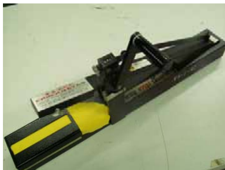
รูปที่ 3.13 เครื่องทดสอบความคงทนต่อการขัดถู (AATCC Crockmeter)
