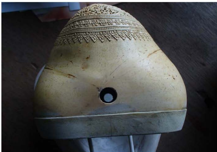
ภาพที่ 134 กะโหลกซอที่เจาะรูเรียบร้อยแล้ว
