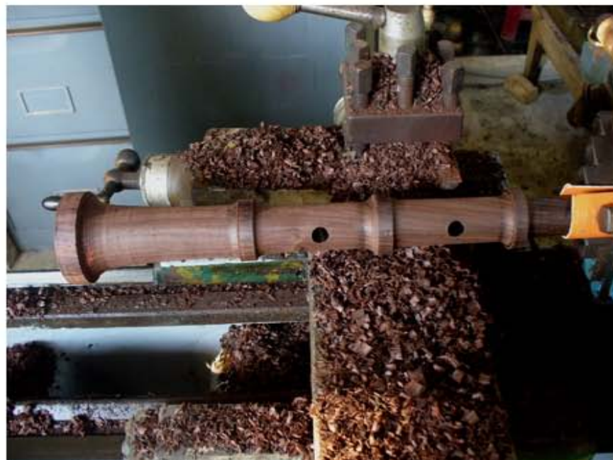
ภาพที่ 163 กลึงทวนบนขึ้นรูปเรียบร้อยแล้ว
