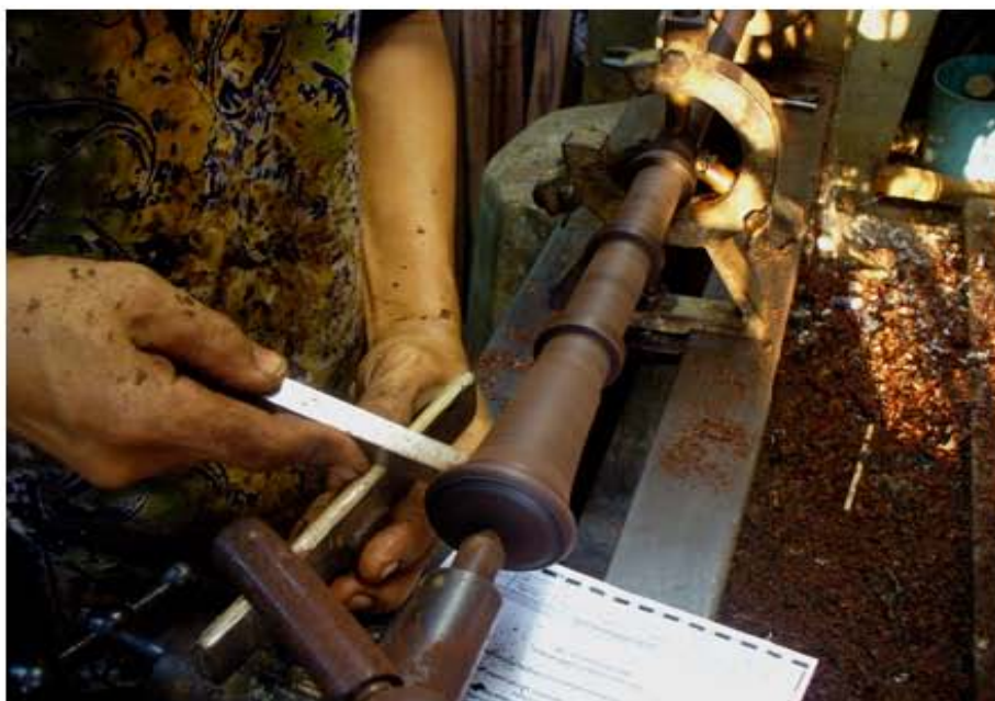
ภาพที่ 164 กลึงไล่ระดับด้วยมีดกลึงขนาดใหญ่
