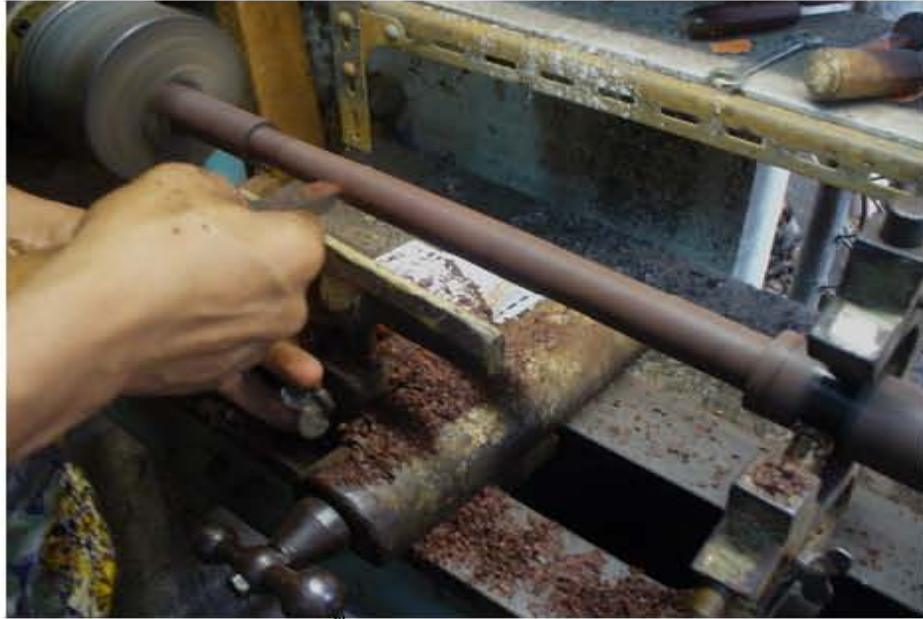
ภาพที่ 155 กลึงชิ้นรูปช่วงทวนล่างด้วยมีดกลึงขนาดใหญ่
