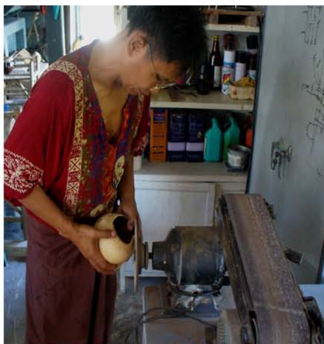
ภาพที่ 99 ขัดผิวกะโหลกขอด้วยเครื่องขัดกระดาษทรายแบบเป็นหมุน
