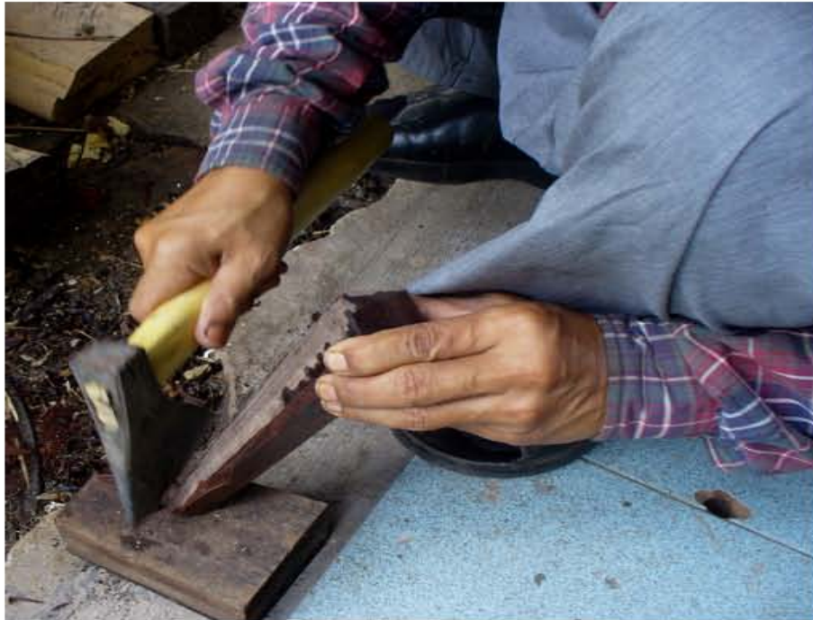
ภาพที่ 187 ลบเหลี่ยมไม้
