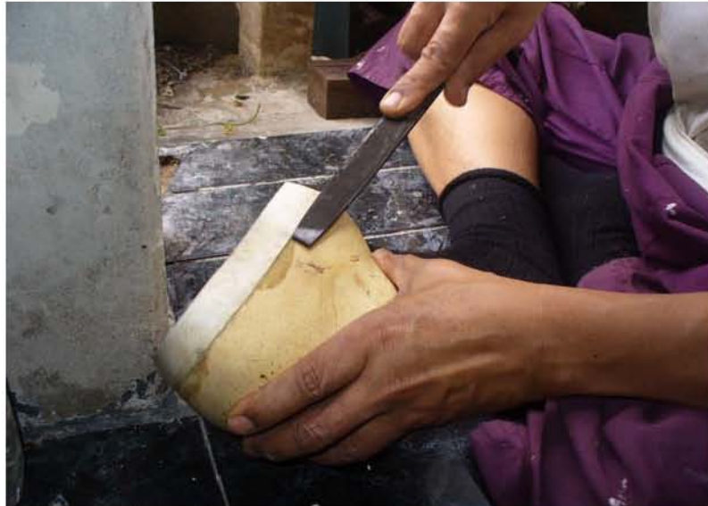
ภาพที่ 129 ใช้ตะไบขัดตกแต่งกะโหลกขอ
