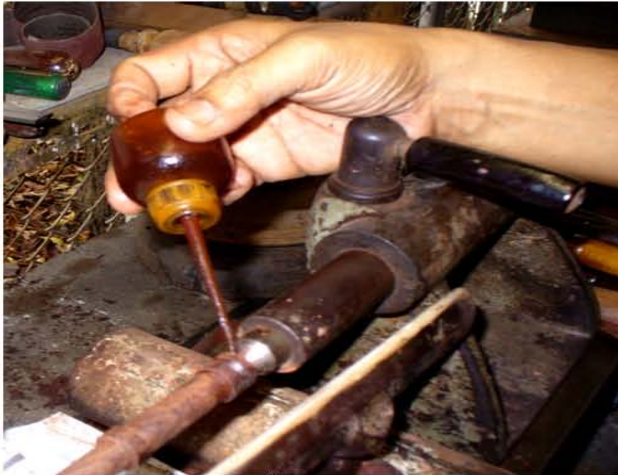
ภาพที่ 227 หยอดน้ำมันหล่อลื่นบนหัวเครื่องกลึง
