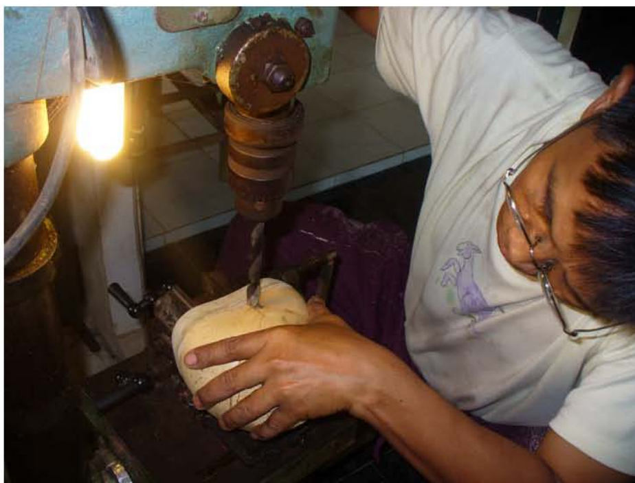
ภาพที่ 132 เจาะกะโหลกซอด้วยแท่นสว่านเจาะ
