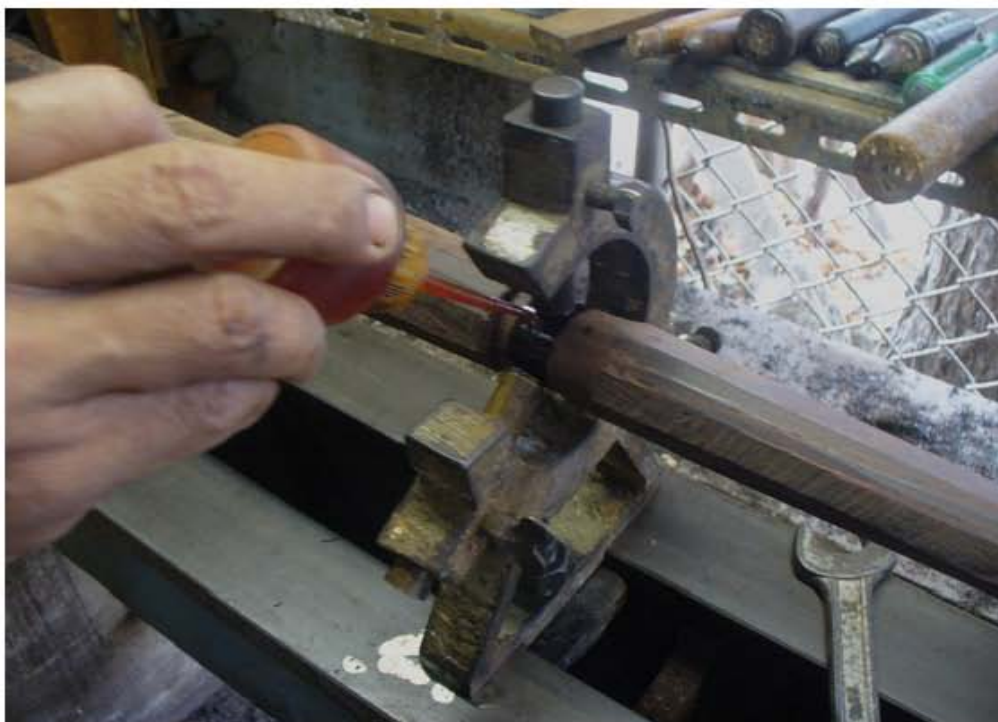
ภาพที่ 147 หยอดน้ำมันหล่อลื่นลงบนตุ๊กตากันสะท้าน
