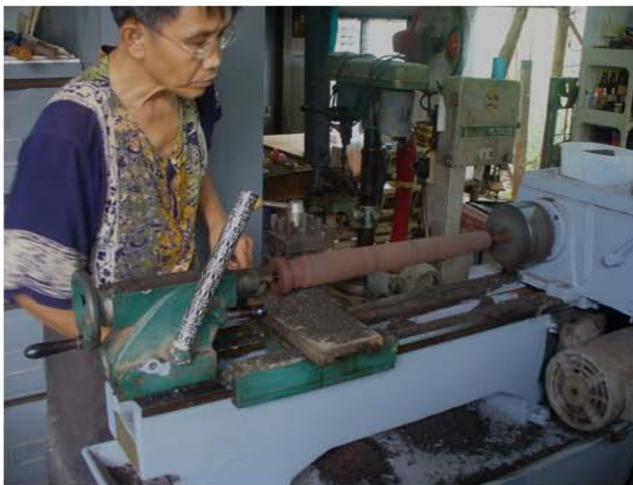
ภาพที่ 151 กลึงขึ้นรูปช่วงคันทวนบนด้วยเครื่องกลึงขนาดใหญ่
