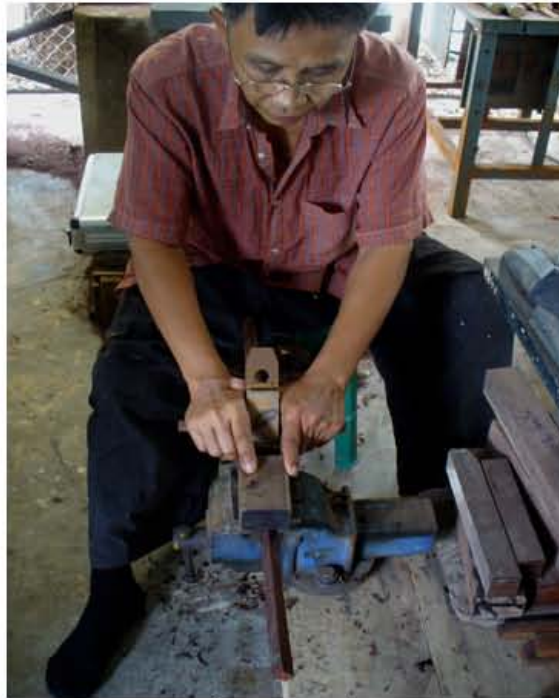
ภาพที่ 216 ลบเหลี่ยมไม้
