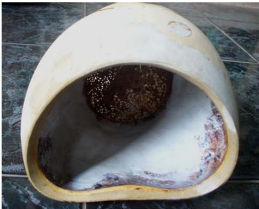
ภาพที่ 111 กะโหลกที่พอกด้านในด้วยกาวอีพ็อกซี
