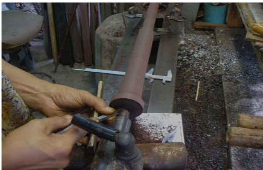
ภาพที่ 153 กลึงขึ้นรูปบนเครื่องกลึงขนาดเล็ก
