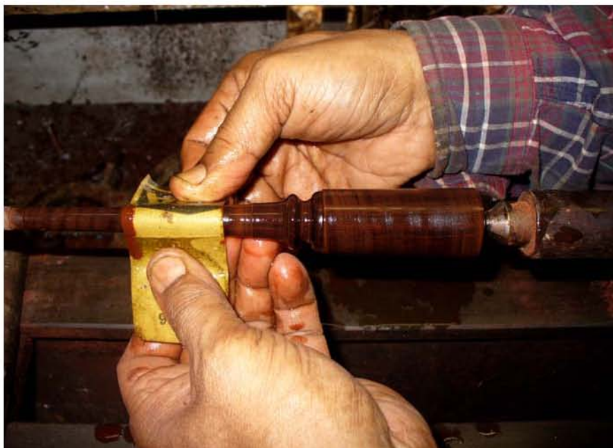
ภาพที่ 204 การขัดน้ำด้วยกระดาษทรายเบอร์ 100 300 360 ตามลำดับ
