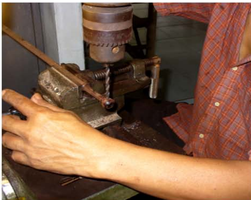
ภาพที่ 230 เจาะรูบริเวณหัวเม็ดปลายคันทัก
