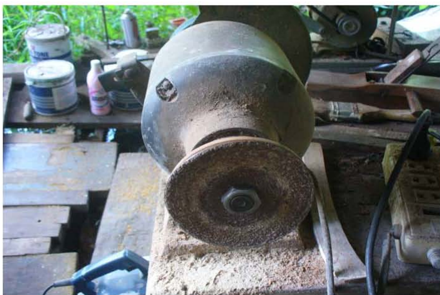
ภาพที่ 52 เครื่องขัดกระดาษทรายแบบเป็นหมุน
