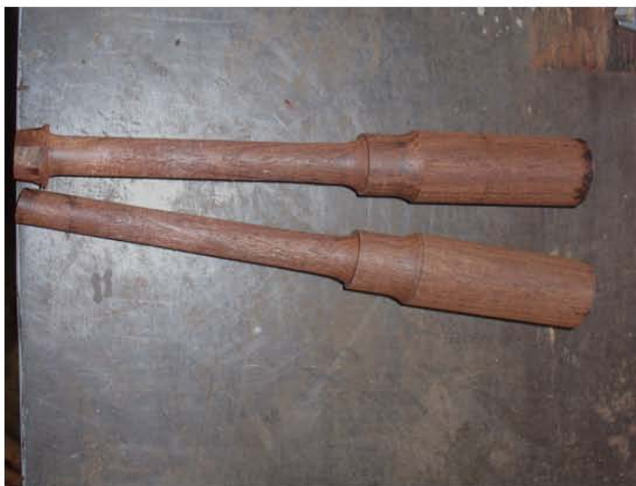
ภาพที่ 193 ไม้ที่กลึงชิ้นรูปเป็นลูกบิดแบบคร่ำวๆ
