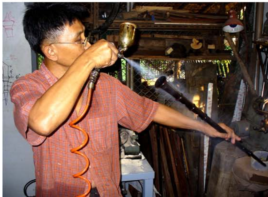
ภาพที่ 179 พ่นแลกเกอร์ในระยะห่าง 30 เซนติเมตร
