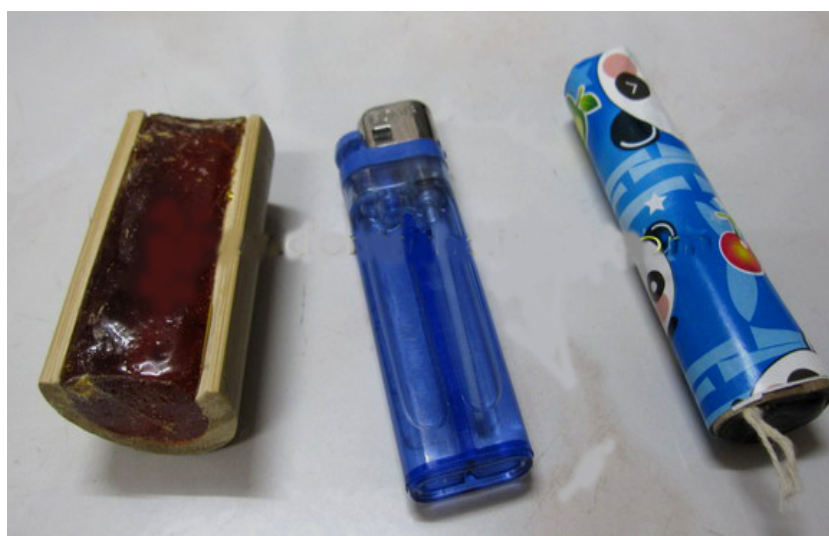
ภาพที่ 289 ยางสนทั่วไปที่มีเนื้อหยาบและฝุ่นมาก
