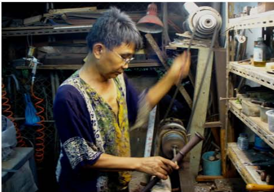
ภาพที่ 174 คว้านขยายรูเสียบลูกบิดด้วยเหล็กคว้านขยายรู
