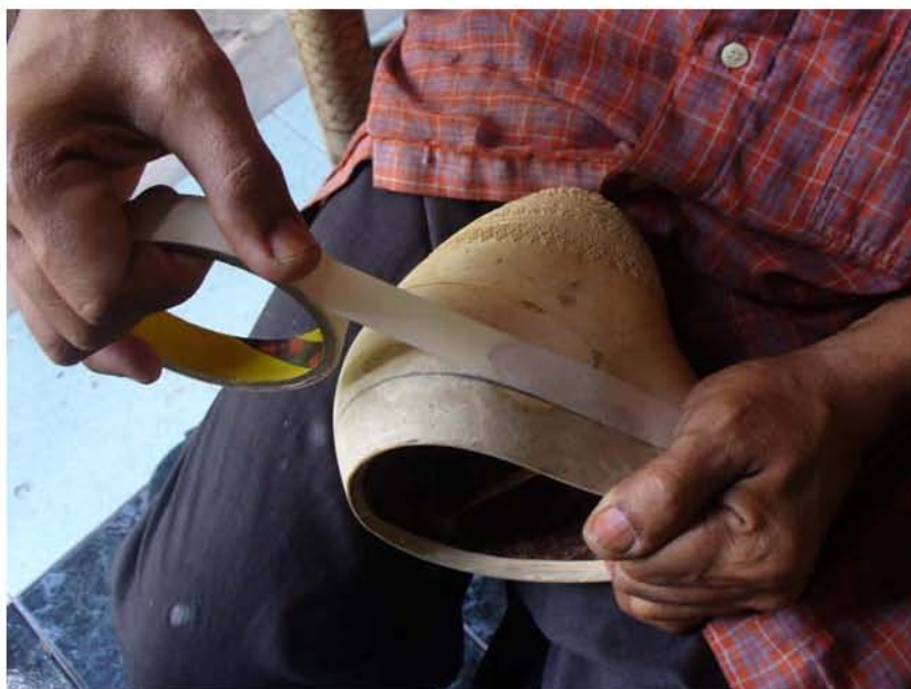
ภาพที่ 121 ใช้กาวหนังไก่พันขอบกะโหลกซอ
