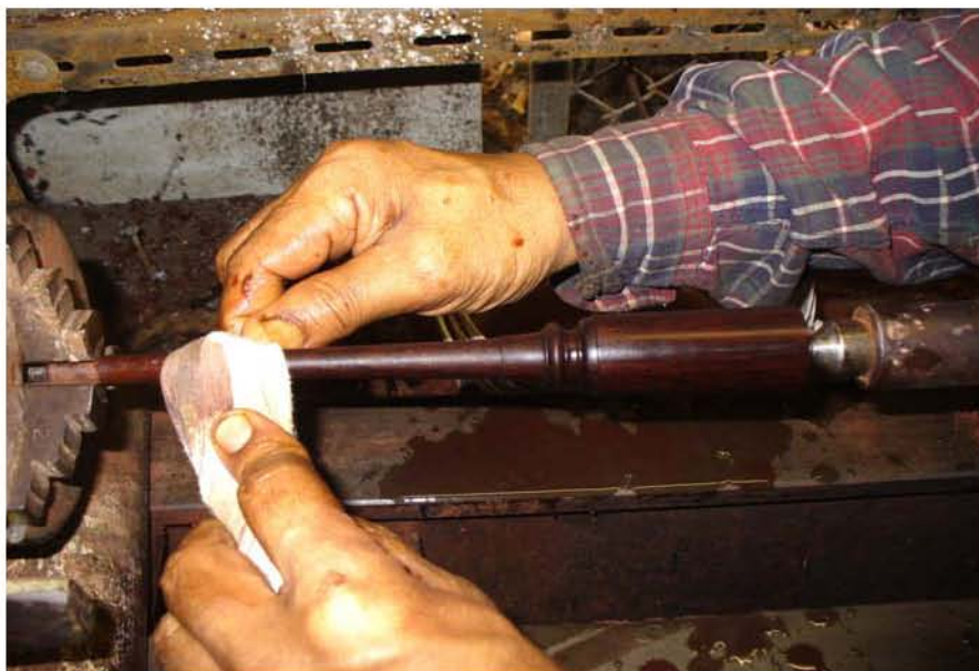
ภาพที่ 205 การขัดแห้งด้วยผ้าขนหนู ขัดแห้งด้วยกระดาษทรายเบอร์ 400 ในขั้นตอนสุดท้าย
