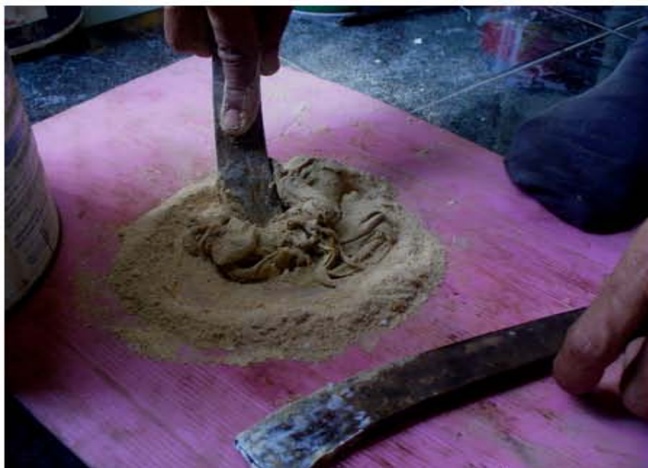
ภาพที่ 105 การใช้ไม้กวนผสมกาวอีฟ็อกซ์และจีเสื่อย
