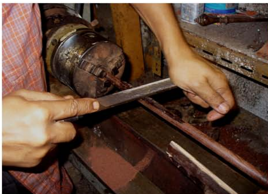
ภาพที่ 221 ขัดให้เรียบด้วยตะไบ
