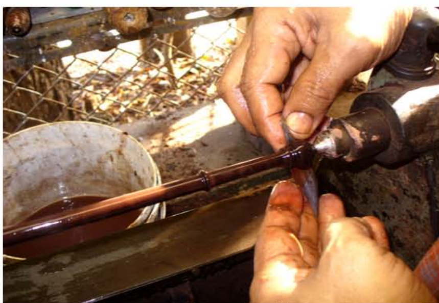
ภาพที่ 236 ขัดด้วยกระดาษทรายน้ำเบอร์ละเอียด
