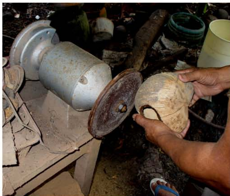
ภาพที่ 40 การขัดผิวกะโหลกชอด้วยเครื่องขัดกระดาษทรายแบบเป็นหมุน
