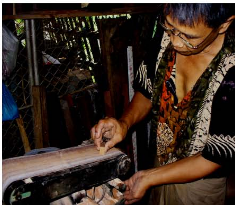
ภาพที่ 253 ขัดขึ้นรูปด้วยเครื่องขัดกระดาษทรายแบบสายพาน
