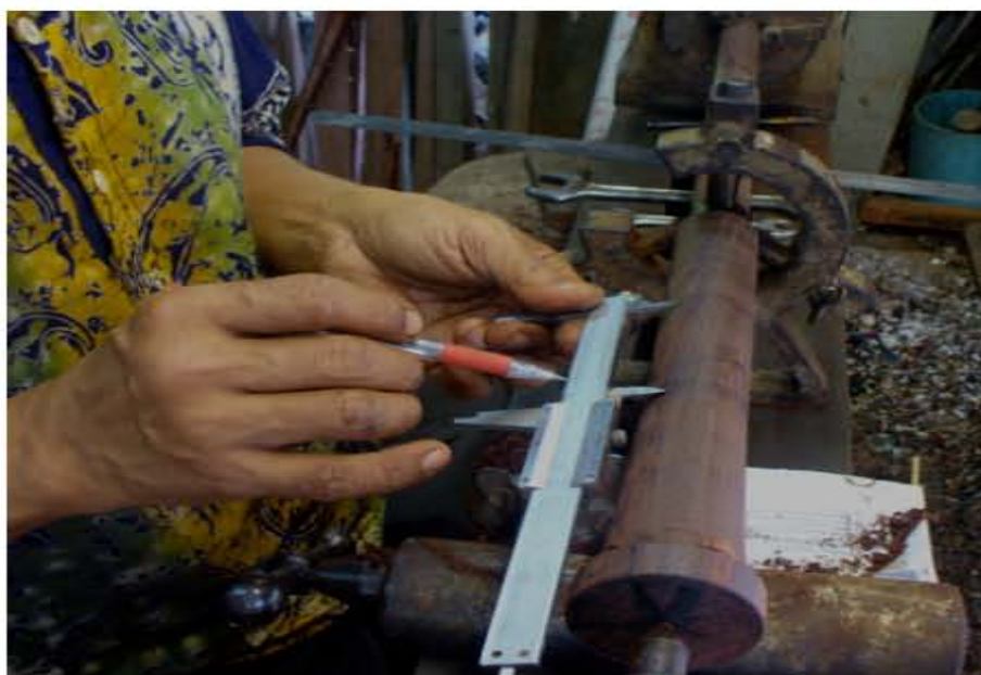
ภาพที่ 154 ใช้เวอร์เนียวัดหาจุดศูนย์กลางการเจาะรูเพื่อใส่ลูกบิด
