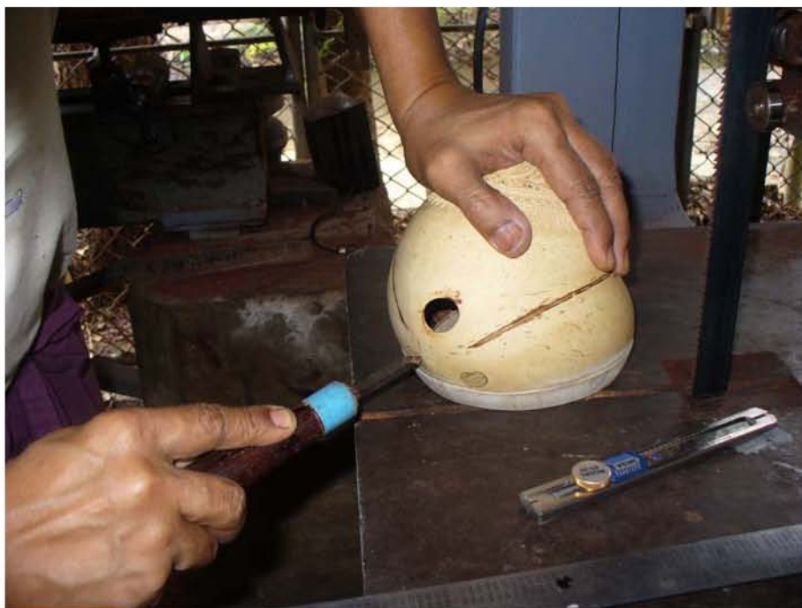
ภาพที่ 131 ใช้มีดคว้านเจาะให้เป็นร่อง จากนั้นนำไปเจาะรูด้วยแท่นสว่านเจาะ โดยจะเล็งด้วยสายตาเพื่อให้การเจาะออกมาได้ ศูนย์กลาง แล้วนำตะไบแบบกลมมาคว้านตกแต่งรูกะโหลกซอให้เรียบร้อย
