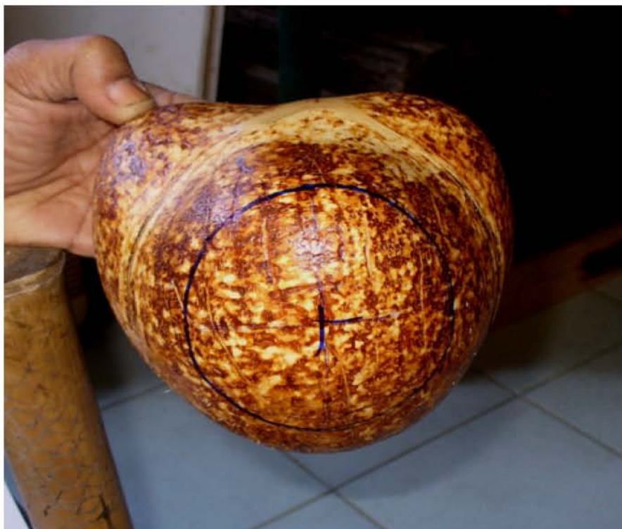
ภาพที่ 97 กะโหลกซอที่กำหนดขนาดเส้นผ่านศูนย์กลางวงกลม 3 นิ้ว
