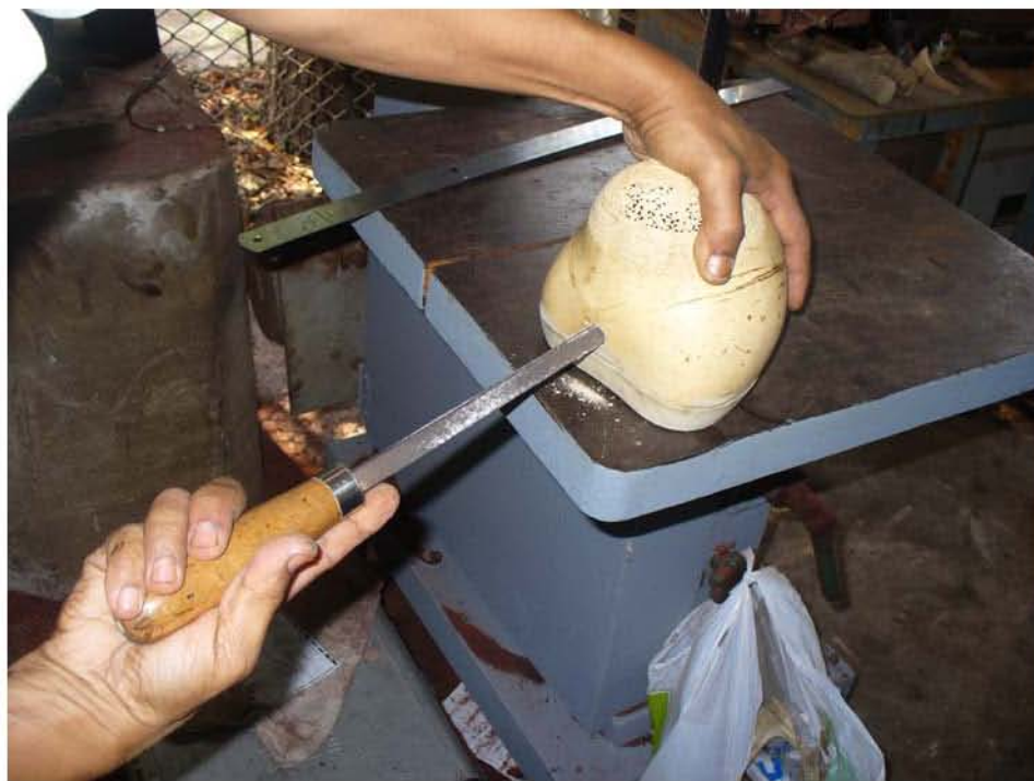
ภาพที่ 133 คิวานแตกแต่งรูด้วยตะไบแบบกลม
