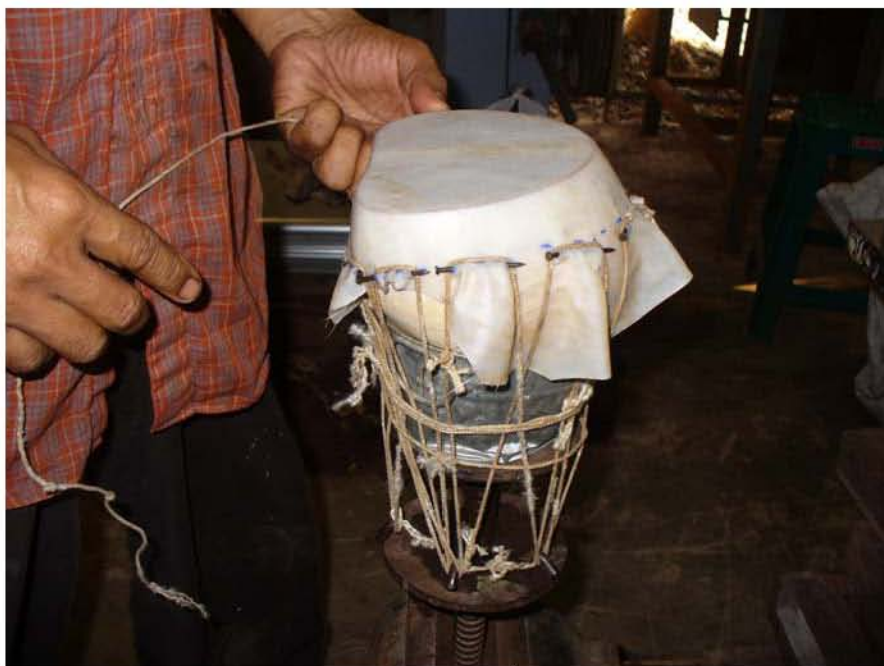
ภาพที่ 125 หมุนเกลียวเครื่องขึ้นหน้าให้มีความตึง
