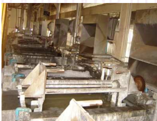
รูปที่ 3.13 เครื่องชุบกัสนิม Phosphate machine
