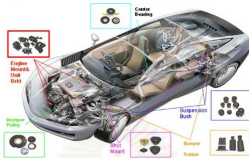
รูปที่ 3.4 ผลิตภัณฑ์ชิ้นส่วนกันสะเทือนภายในรถยนต์
