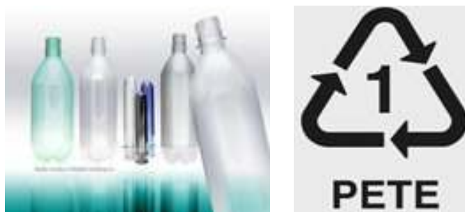
ภาพที่ 2.3 พอลิเอทิลีนเทอเรฟทาเลตและสัญลักษณ์ (ศูนย์เทคโนโลยีโลหะและวัสดุแห่งชาติ, 2550 : ออนไลน์)
