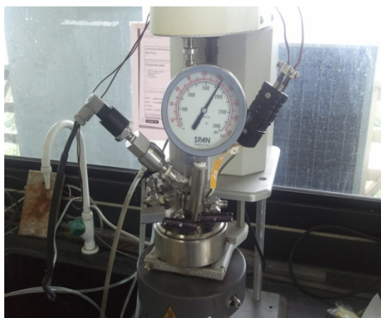
รูปที่ 3.7 เอสเทอร์ฟิเคชันในเครื่องปฏิกรณ์ความดันสูง
