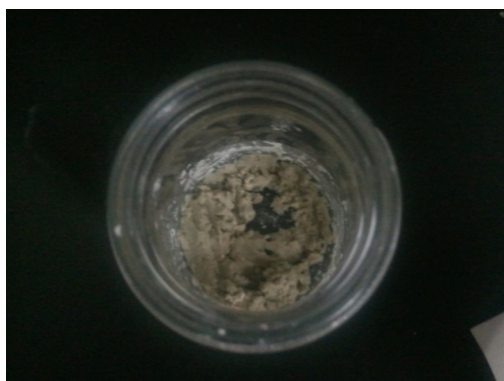
รูปที่ 3.4 สารที่มีลักษณะเป็นก้อนเค้กเปียก (wet cake)
