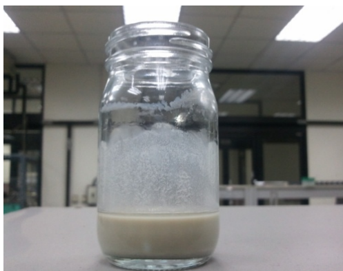
รูปที่ 3.3 มอนต์มอริลโลไนต์ในสารละลาย H_3PW_{12}O_{40}
