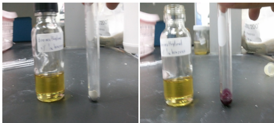
รูปที่ 4.4 ตัวอย่างการเปลี่ยนแปลงสีของอินดิเคเตอร์ที่ใส่ลงในตัวเร่งปฏิกิริยาโดยใช้ bromothymol blue เป็นอินดิเคเตอร์
