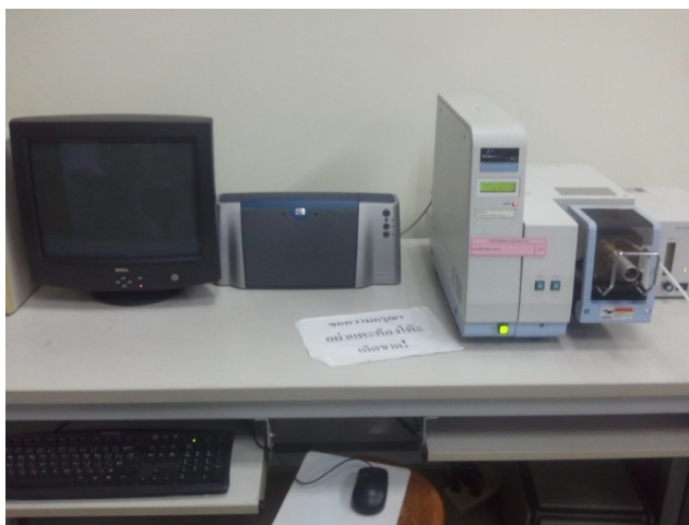
รูป 3.2 เครื่อง thermal analyzer รุ่น Pyris Diamon ของ Perkin Elmer
