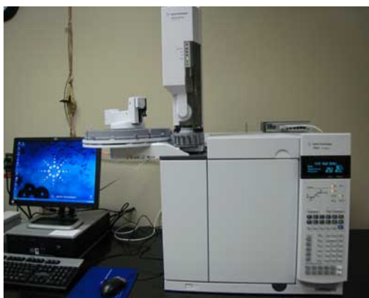
รูปที่ 3.8 แก๊สโครมาโทกราฟี รุ่น 7890A ของบริษัท Agilent Technologies
