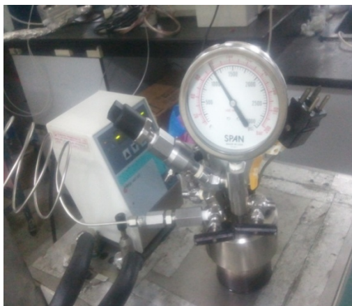
รูปที่ 3.6 แสดงการอัดแก๊สคาร์บอนไดออกไซด์ด้วยเครื่องปั๊มแรงดันสูง
