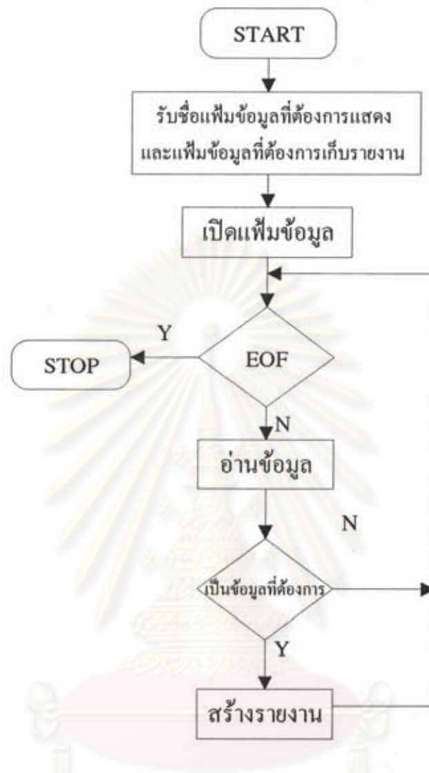
รูปที่ 5.9 แสดงผังแสดงการทำงานโปรแกรมสร้างรายงานการใช้เพิ่มข้อมูลตามเวลา (LISTALL)
