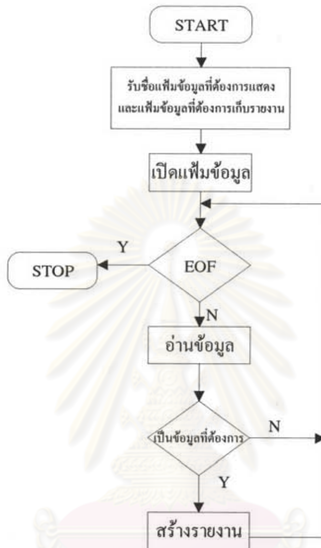
รูปที่ 5.4 แสดงผังการทำงานของโปรแกรมสร้างรายงานการใช้และเลิกใช้ (LOGIN)
