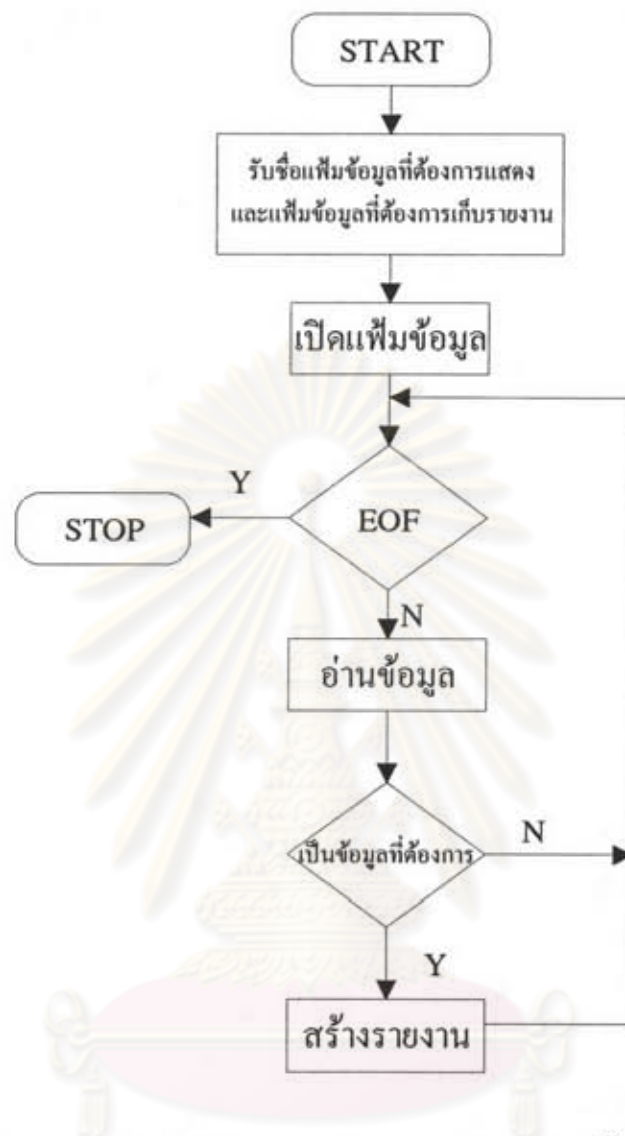
รูปที่ 5.6 แสดงผังแสดงการทำงานของโปรแกรมสร้างสรุปรายการใช้งานทั้งหมด (ATOTAL)
