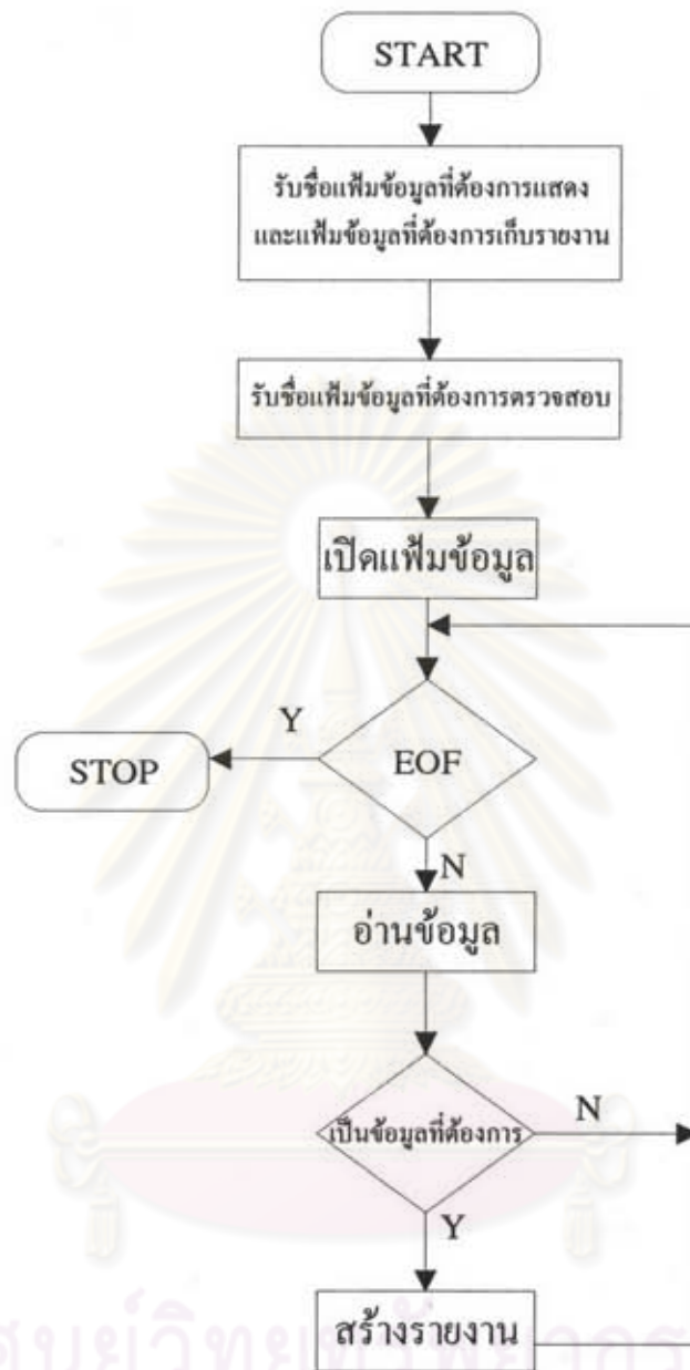
รูปที่ 5.7 แสดงผังแสดงการทำงานของโปรแกรมสร้างรายงานการใช้เพิ่มข้อมูลที่กำหนด (LISTFLE)
