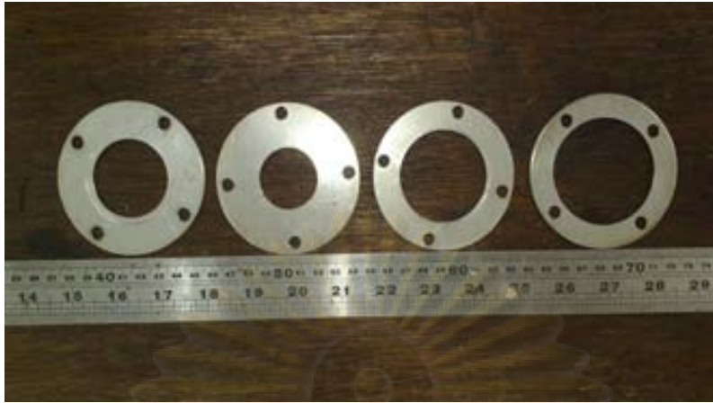
รูปที่ ก-3 แสดงลักษณะของแผ่นบีฟเฟิลที่ขนาดรูภายในต่างกัน
