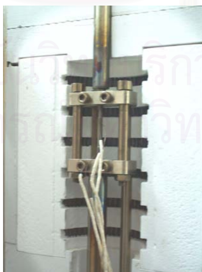
รูปที่ 5.11 การติดตั้งขึ้นงานทดสอบและเกจวัดระยะเคลื่อนตัว
