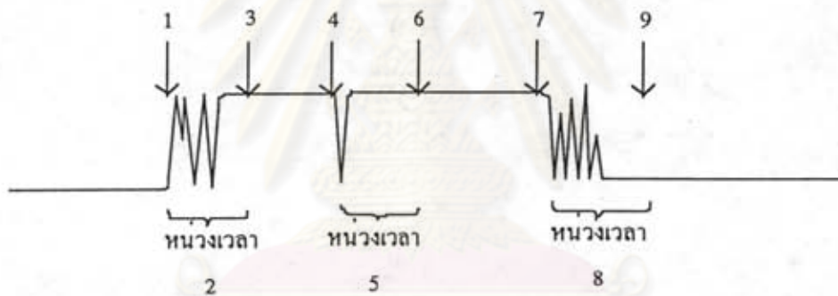
รูปที่ ก.2.3 แสดงวิธีการ debounce สวิตช์
