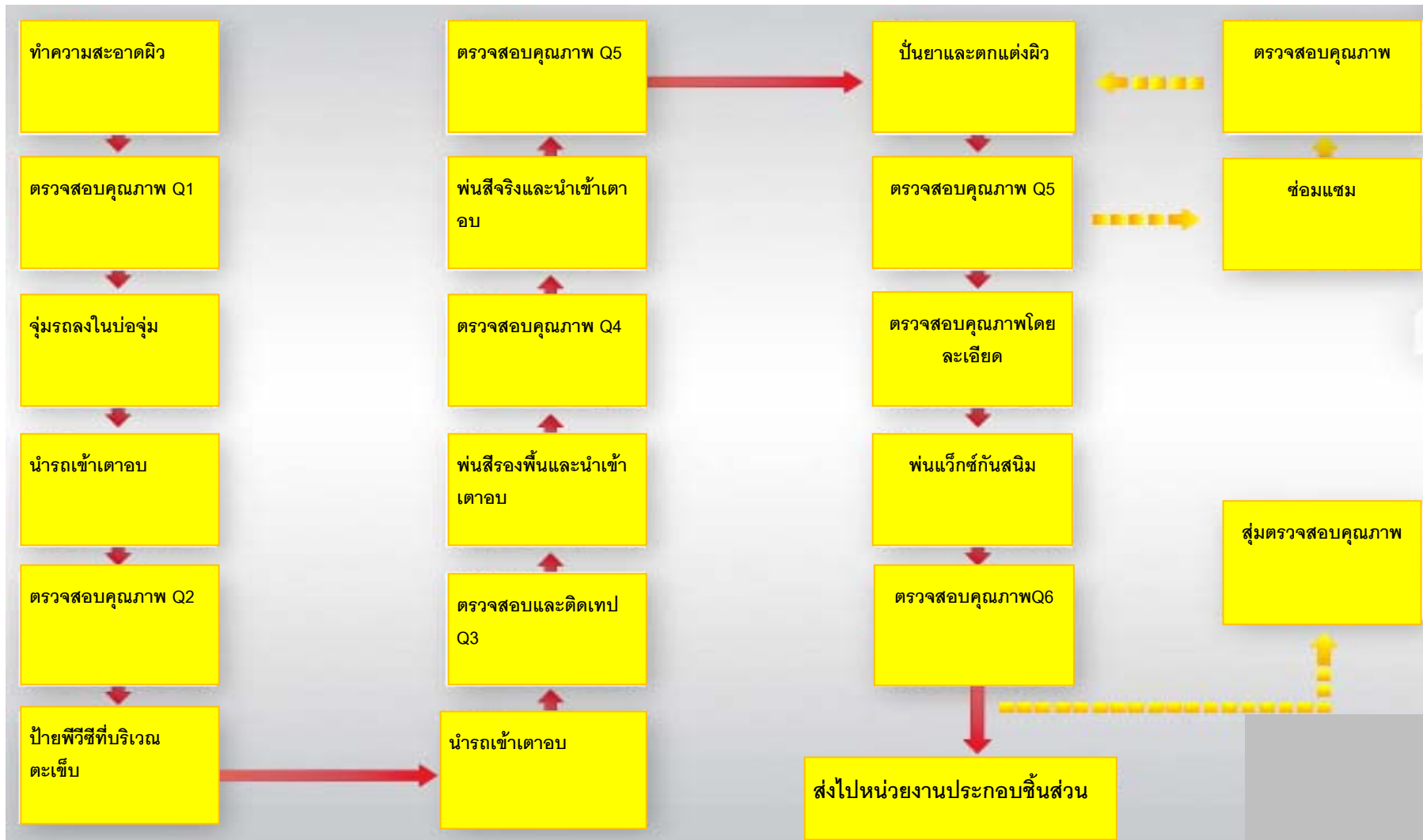
ภาพที่ 3.8 กระบวนการทำสีรถยนต์
