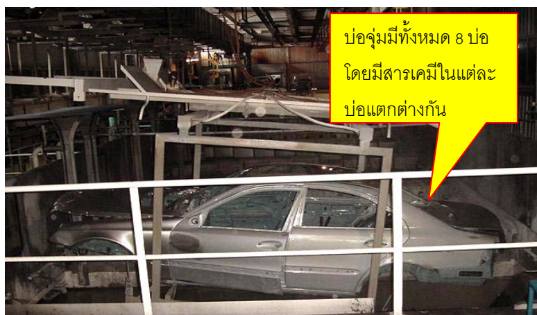
ภาพที่ 8.12 บ่อจุ่มเพื่อล้างสิ่งสกปรกและปรับสภาพผิวของรถยนต์
