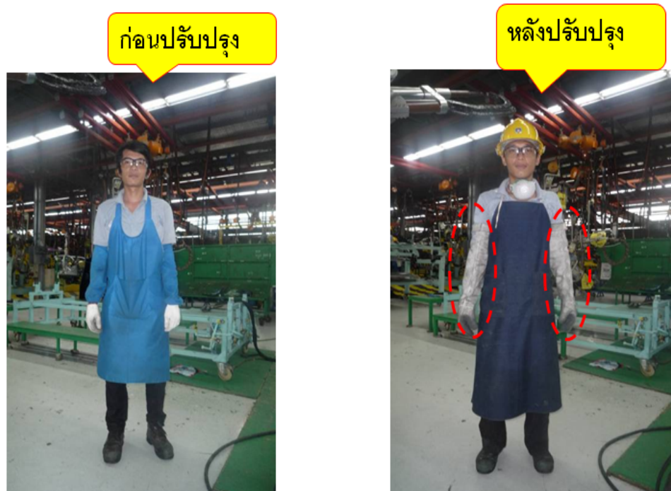
ภาพที่ 7.47 ตัวอย่างการสวมปลอกแขนเพื่อป้องกันชิ้นส่วนขนาดที่แขน
