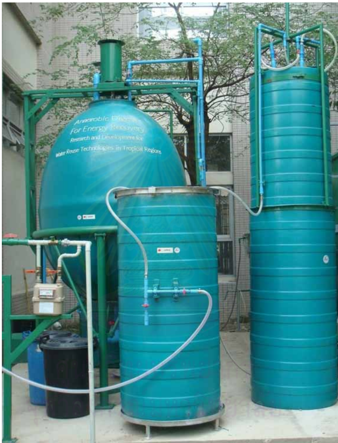
ภาพที่ 3.4 ระบบถังหมักภายใต้สภาวะไร้ออกซิเจนแบบสองขั้นตอน (two-stage anaerobic digestion) ในระดับภาคสนาม (ด้านหลัง)
