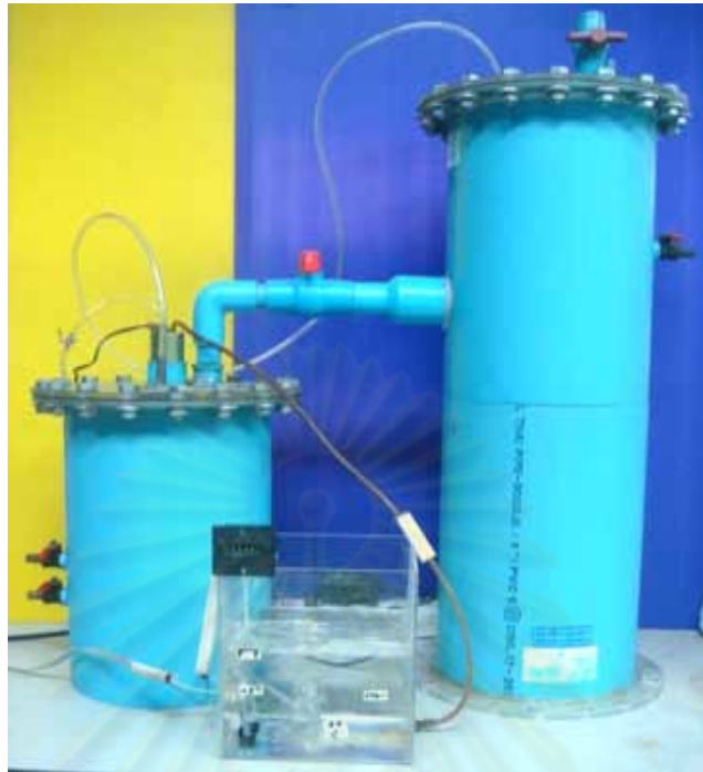
ภาพที่ 3.1 ระบบถังหมักภายใต้สภาวะไร้ออกซิเจนแบบสองขั้นตอน (two-stage anaerobic digestion) ในระดับห้องปฏิบัติการ
