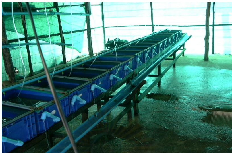
ภาพที่ 14 หน่วยทดลองระบบน้ำหมุนเวียนแบบกึ่งปิด (Semi-closed water circulation system)
