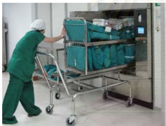
ภาพที่ 4.17 นำห่อชุดอุปกรณ์เข้าสู่เครื่องทำให้ปราศจากเชื้อด้วยการนึ่งไอน้ำ
