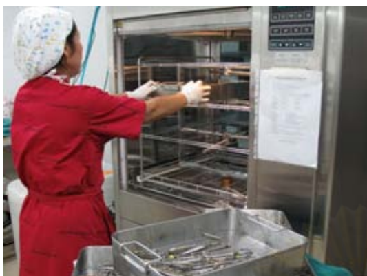
ภาพที่ 4.9 ล้างทำความสะอาดด้วยเครื่องล้างอัตโนมัติ (Washer) แบบ 2 way
