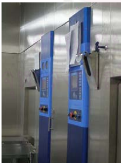
ภาพที่ 2.27 บริเวณติดตั้งเครื่อง ทำให้ปราศจากเชื้อ ชนิดน้ำ (Autoclave)
