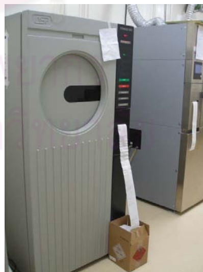
ภาพที่ 2.28 บริเวณติดตั้งเครื่องทำปราศจากเชื้อ ชนิดพลาสมา
