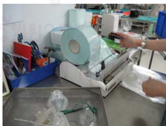
ภาพที่ 4.14 นำอุปกรณ์ฯที่ต้องอบแก๊สมาจัดบรรจุด้วย Sterilization pouch
