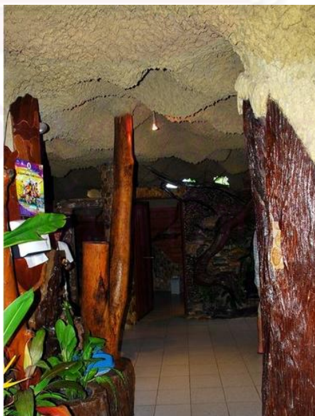
ภาพที่ 4-20 ออกแบบภายในให้หลังคามีลักษณะคล้ายถ้ำ ทำให้อุณหภูมิภายในเย็นกว่าภายนอก
