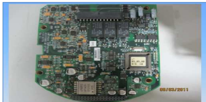
Relay Card ภายในของ MOV 11-XVM-711 ที่ได้ทำการเปลี่ยนใหม่ (เป็น Card ที่สั่ง Status Contact Valve OPEN/CLOSE)
