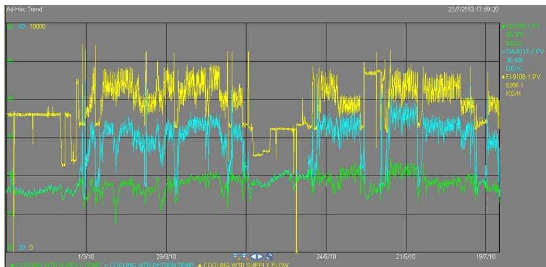
รูป 5.2 Flow rate และ Temperature CWR, CWS Record ปัจจุบัน
