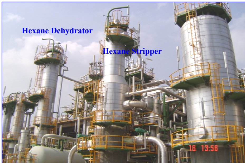
รูป 5.11 หอกกลั่นที่ใช้ในกระบวนการกลั่น Hexane ให้เป็น Pure Hexane
