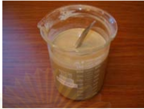
รูปที่ 2.8 แสดงตัวอย่างของเบนโทไนท์ผงและเมื่อผสมกับน้ำ
