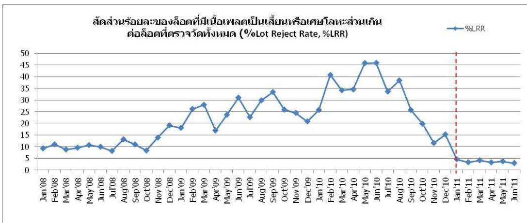
ภาพที่ 7.1 แนวโน้ม%LRR ของเสียที่มีเนื้อเพลตเป็นเสี้ยนหรือโลหะส่วนเกิน ก่อนและหลังการปรับปรุง
