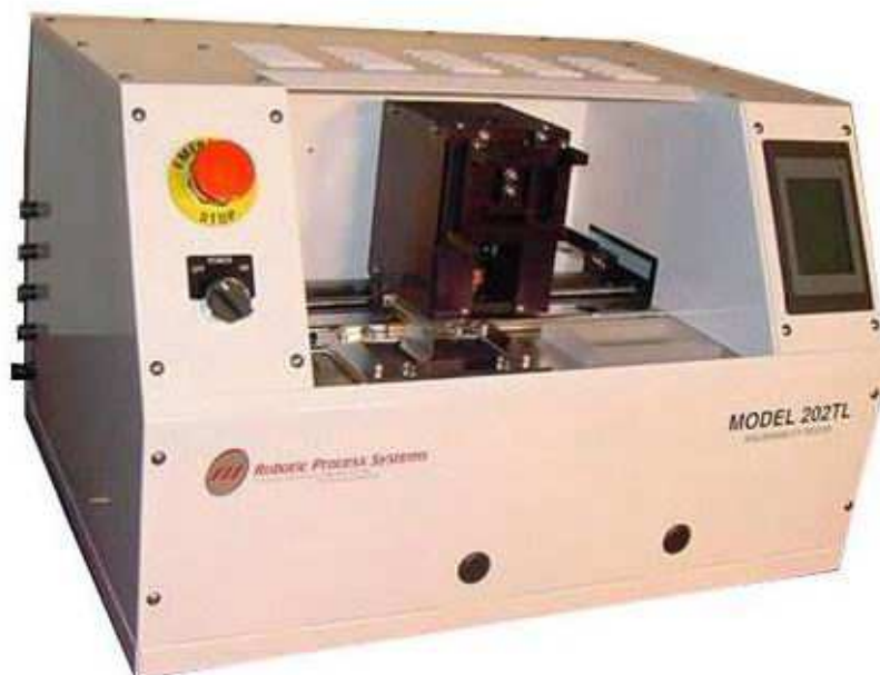
ภาพที่ 3.12 เครื่องทดสอบความสามารถในการยึดเกาะกับสารเชื่อมวงจรไฟฟ้าหรือ เครื่องทดสอบ Solderability
