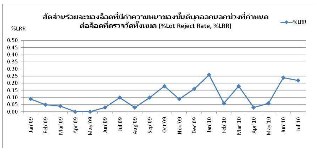
ภาพที่ 4.5 สัดส่วนร้อยละของลืตที่มีค่าความหนาของชั้นดีบุกออกนอกช่วงที่กำหนด
