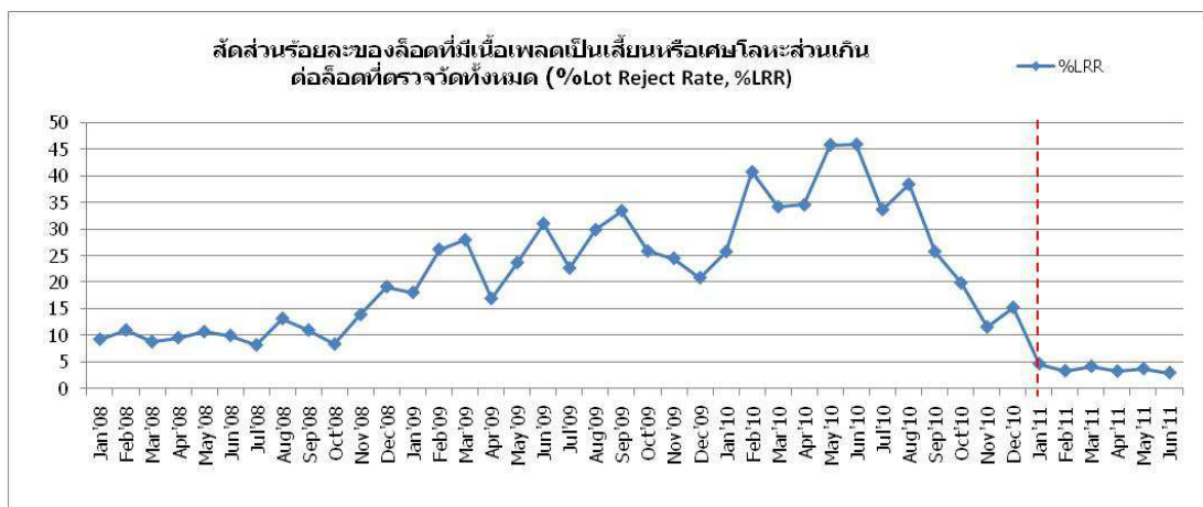
ภาพที่ 6.21 แนวโน้ม %LRR ของเสียที่มีเนื้อเพลตเป็นเสี้ยนหรือโลหะส่วนเกิน ก่อนและหลังการปรับปรุง
