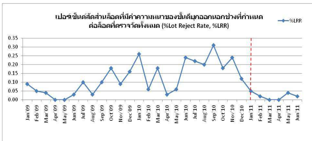
ภาพที่ 7.2 แนวโน้ม %LRR ของเสียที่มีค่าความหนาชั้นดีบุกออกนอกช่วงที่กำหนด ก่อนและหลังการปรับปรุง
