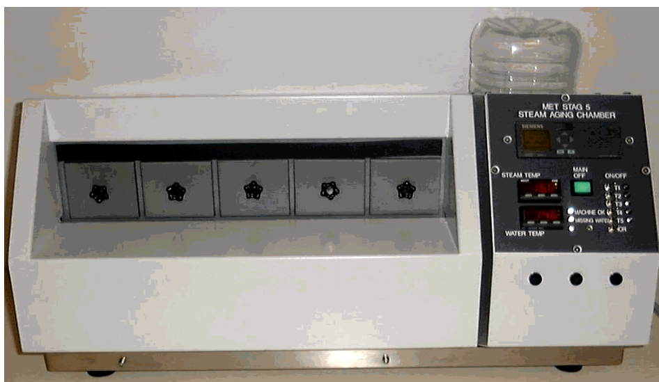
ภาพที่ 3.11 เครื่องอบไอน้ำ (Steam aging chamber)
