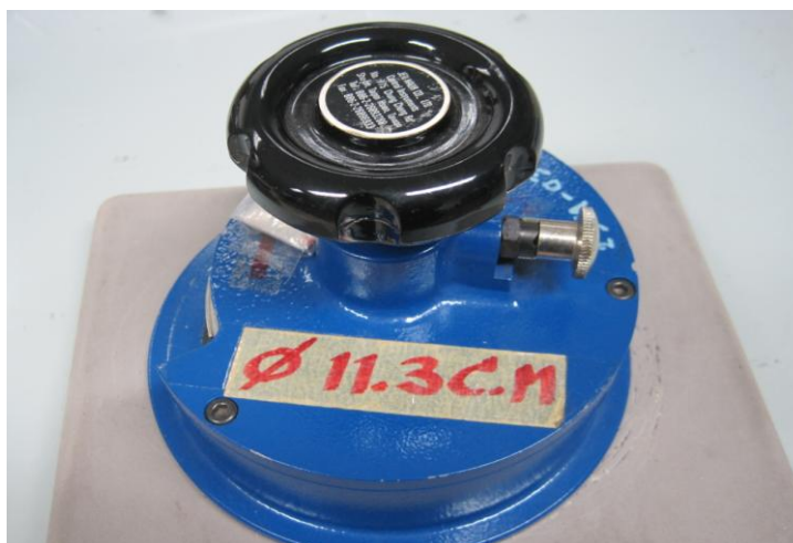
ภาพที่ 3.2 เครื่องตัดผ้าวงกลม (fabric sample cutter)
