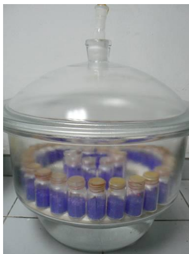
ภาพที่ ก. 1 การทดสอบความสามารถในการซึมผ่านไอน้ำของแผ่นฟิล์มภายในเดซิเคเตอร์
