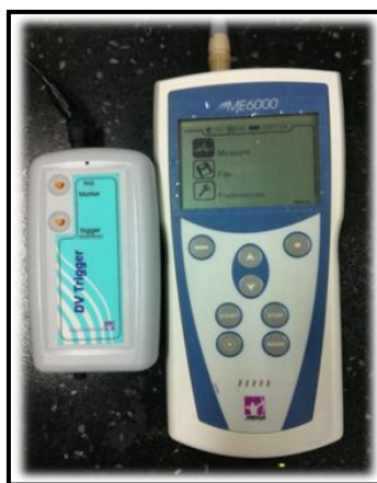
ภาพที่ 3.4 เครื่องวัดสัญญาณไฟฟ้ากล้ามเนื้อ # ME 6000
