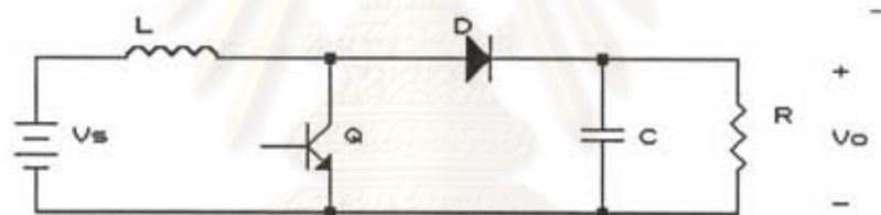
รูปที่ 2.8 วงจรทบทระดับ (BOOST)
