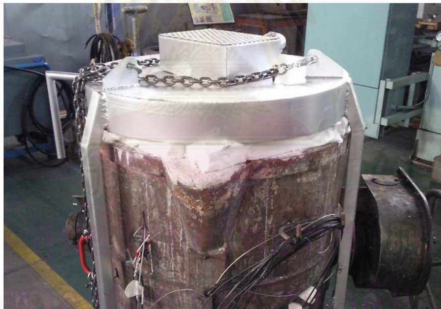
รูปที่ 4.28 สภาพของเบ้ารับน้ำเหล็กเมื่อประกอบชุดฮีตเตอร์ไฟฟ้าเรียบร้อยแล้ว
