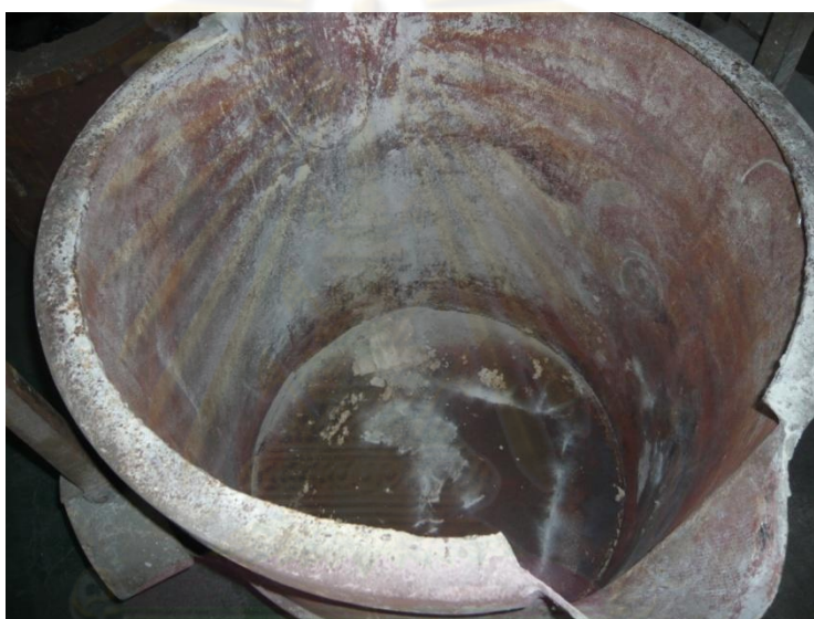
รูปที่ 4.11 สภาพของตัวถังเหล็กของเบ้ารับน้ำเหล็กเมื่อรื้อผนังเบ้ารับน้ำเหล็กออกแล้ว
