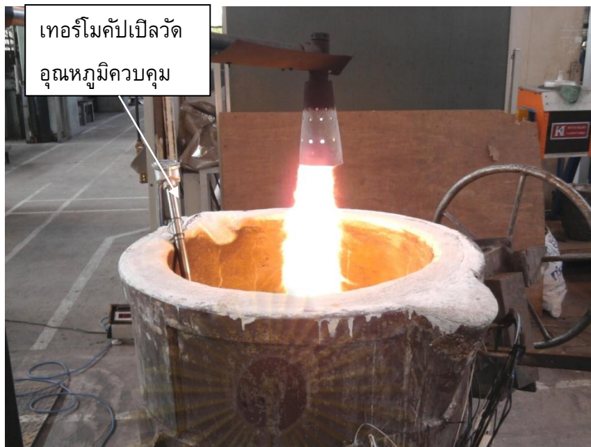
รูปที่ 4.26 ขณะทำการอุ่นเบ้ารับน้ำโลหะด้วยน้ำมันดีเซล เทอร์โมคัปเปิลที่วางพาดกับปากเบ้า ด้านซ้ายมือคือเทอร์โมคัปเปิลควบคุมที่วัดอุณหภูมิสำหรับใช้ในการควบคุมการอุ่นเบ้า
