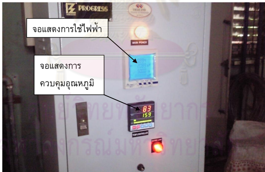
รูปที่ 4.30 แผงควบคุมการทำงานของชุดฮีตเตอร์ไฟฟ้าอุ่นเบ้ารับน้ำเหล็ก
