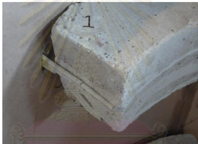
รูปที่ 4.15 การสอดสายเทอร์โมคัปเปิลทะลุตัวถังเหล็กไปยังอุปกรณ์วัดนอกบ้าน
