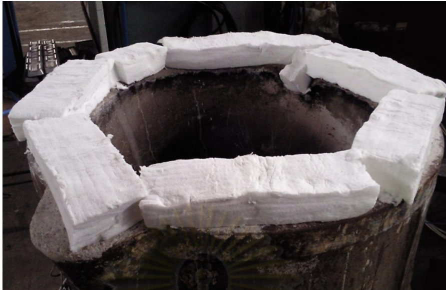
รูปที่ 4.27 การวางใยเซรามิกบนขอบเบ้ารับน้ำเหล็ก เพื่อรองรับชุดฮีตเตอร์ไฟฟ้า และป้องกันการสูญเสียความร้อนออกจากเบ้าในขณะที่ทำการอุ่นเบ้า
