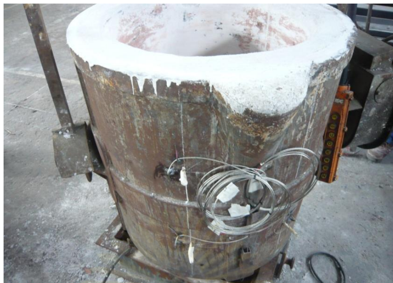
รูปที่ 4.18 เบ้ารับน้ำเหล็กที่ก่อผนังเสร็จแล้ว และสายต่อเทอร์โมคัปเปิลข้างเบ้า ในสภาพที่พร้อมสำหรับการทดลอง
