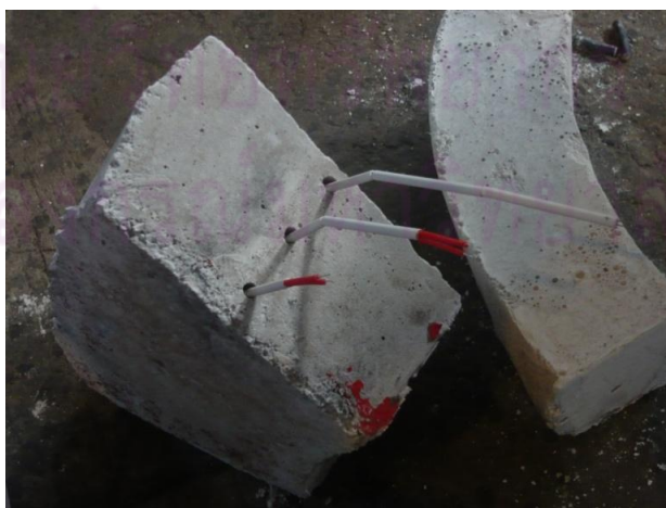
รูปที่ 4.13 การสอดฝังเทอร์โมคัลเปิลเข้าไปในแท่งวัสดุทนไฟ
