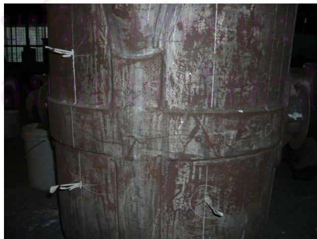
รูปที่ 4.16 ปลายเทอร์โมคัปเปิลแต่ละตำแหน่งที่สอดทะลุตัวถังเหล็กออกมานอกบ้าน เพื่อต่อไปยังตัวบันทึกข้อมูล
