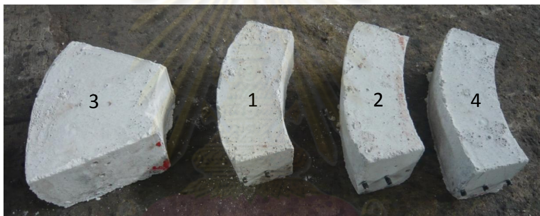
รูปที่ 4.12 แท่งวัสดุทนไฟที่หล่อขึ้นเพื่อใช้ฝังเทอร์โมคัลเปิลจำนวน 4 ก้อนเพื่อติดตั้งบนผนังข้างและก้นของเบ้ารับน้ำเหล็ก
