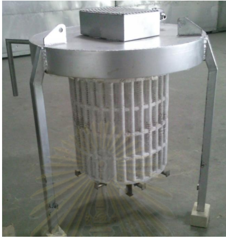
รูปที่ 4.23 ลักษณะทั่วไปของชุดฮีตเตอร์ไฟฟ้าที่สร้างขึ้นในงานวิจัยนี้
