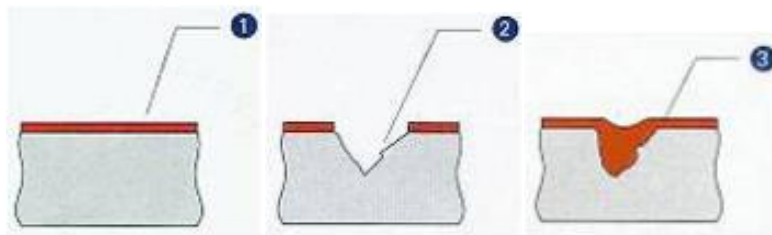
ภาพที่ 2.2 การเกิด passive layer ของเหล็กกล้าไร้สนิม
