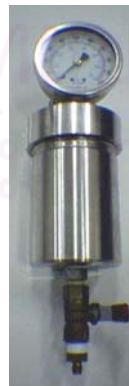
รูปที่ 3.7 เครื่องเก็บผลิตภัณฑ์ไดเมทิลอีเทอร์
