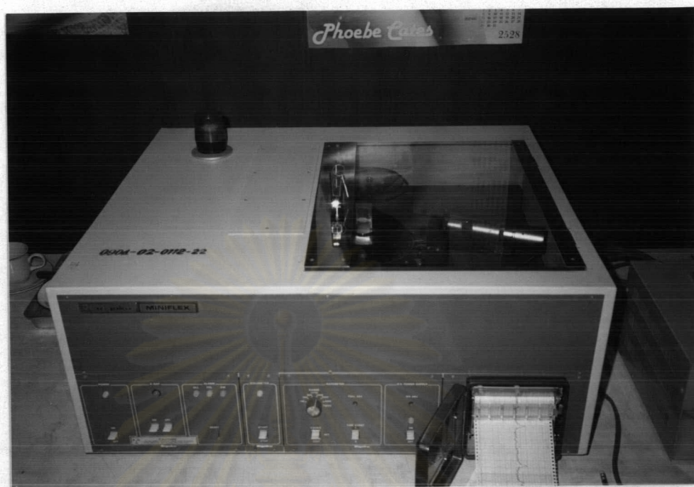
รูปที่ ก.3 เครื่องรังสีเอกซ์เลี้ยวเบนยี่ห้อฟ็อก
