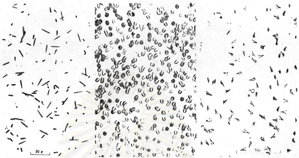
รูปที่ 2.3 ลักษณะรอยอนุภาคหลังจากถูกกัดขยายรอยด้วยสารละลายเคมี
