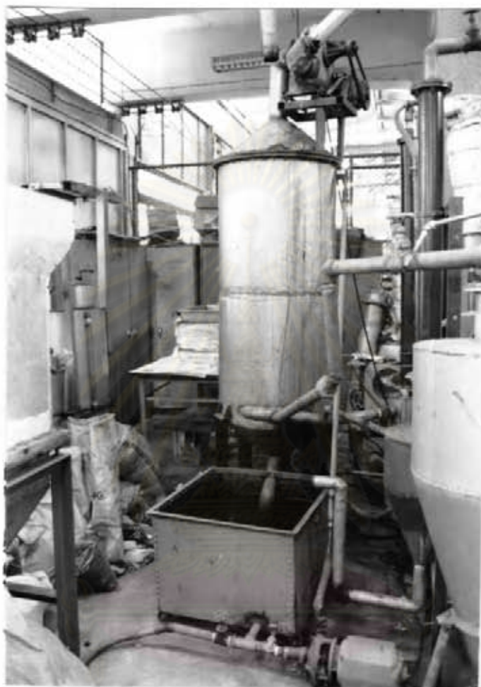
ศูนย์วิทยทรัพยากร รูปที่ 3.9 แสดงระบบกำจัดก๊าซแบบดูดซึม จุฬาลงกรณ์มหาวิทยาลัย
