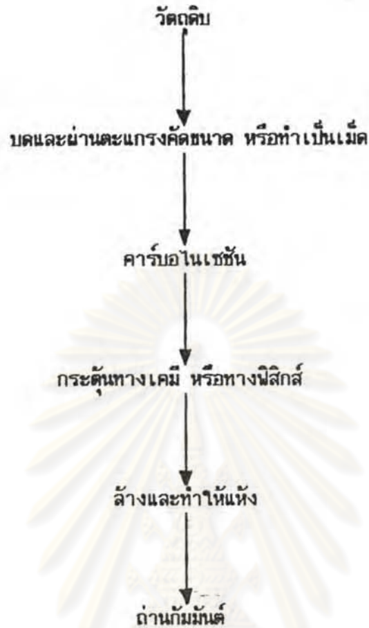
รูปที่ 2.12 แสดงกระบวนการผลิตถ่านกัมมันต์
