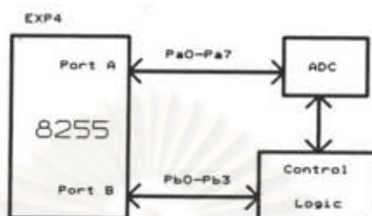
รูปที่ 3.13 แผนภาพการต่อใช้งานของพอร์ต EXP4
