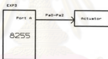
รูปที่ 3.14 แผนภาพการต่อพอร์ต EXP3 เพื่อควบคุมลูกรีด
