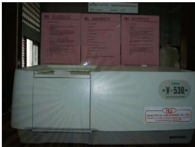
รูปที่ 3.9 เครื่องยูวี-วิสิเบิล สเปกโทรโฟโตมิเตอร์
