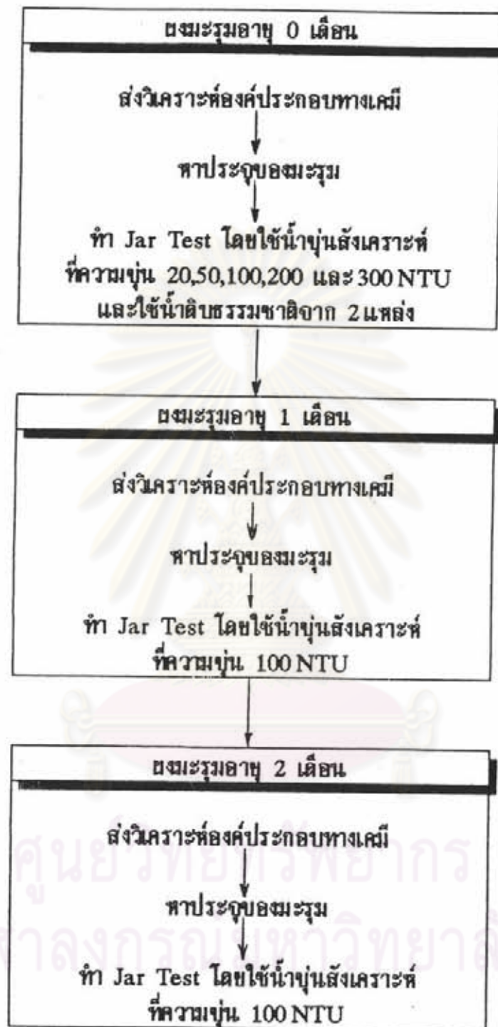
รูปที่ 3.1 ขั้นตอนการทดลองโดยสรุป
