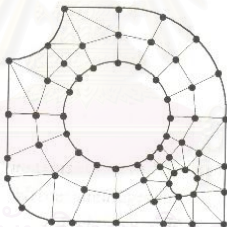
รูปที่ 2.11 การหาผลเฉลยบนแผ่นโลหะด้วยวิธีการไฟไนต์เอลิเมนต์ (ปราโมทย์ เดชะอำไพ, 2542)
