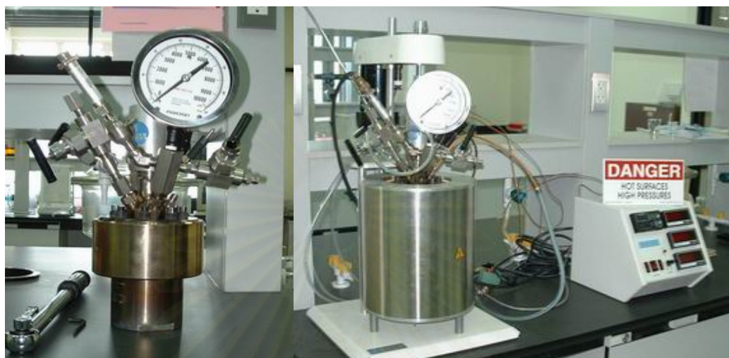
รูปที่ 3.1 เครื่องปฏิกรณ์ Parr Reactor Model 4842
