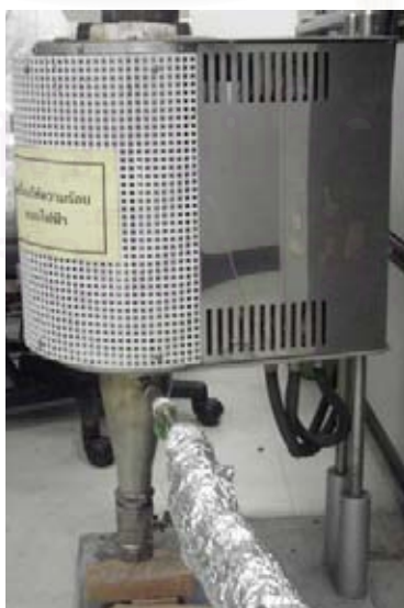
รูปที่ 3.3 เตาเผาให้ความร้อนแบบท่อกลวง (Tubular Furnace)
