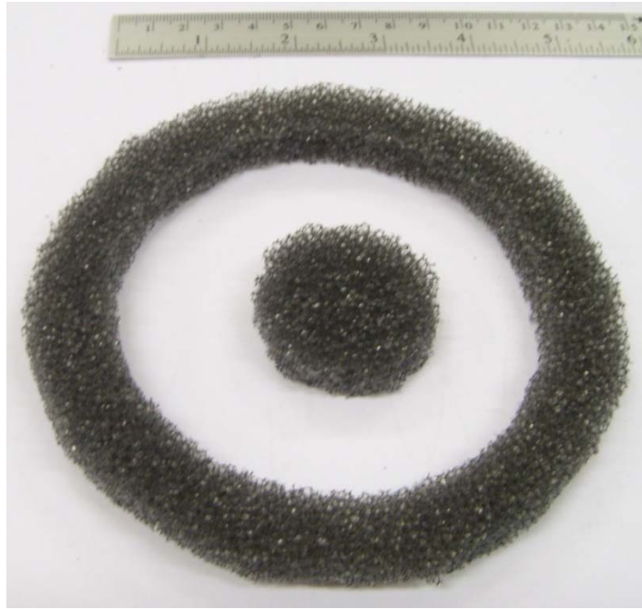
รูปที่ 3.14 โฟมที่ตัดเป็นรูปห้องบรรจุของเหลวแม่เหล็ก
