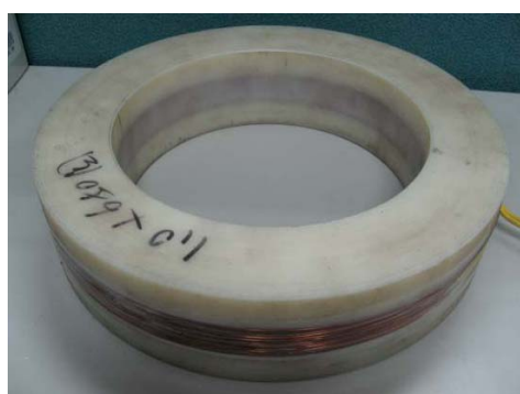
รูปที่ 2.22 ขนาดของปลอกพลาสติกที่พันด้วยลวดทองแดง (จาก Wu และคณะ, 2008)
