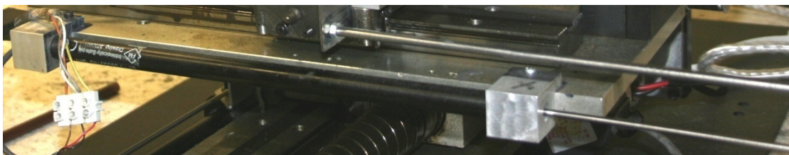
รูปที่ 4.5 เครื่องวัดระยะติดตั้งบนเครื่องจำลองแผ่นดินไหว
