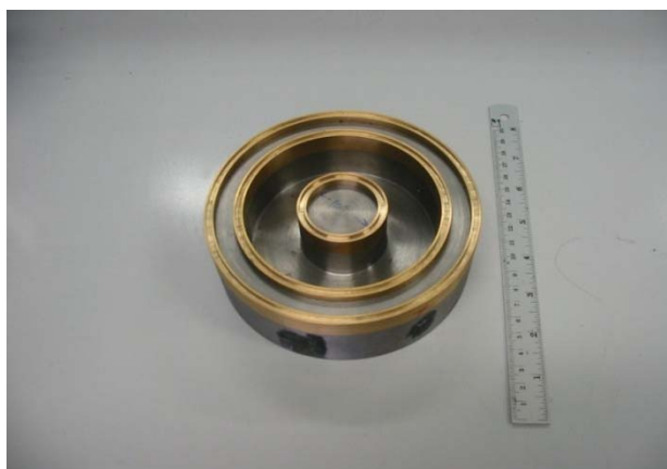
รูปที่ 3.6 แบ็งจ์ตัวหม้อของเหลวแม่เหล็กก่อนทำการติดตั้งขดลวดทองแดง
