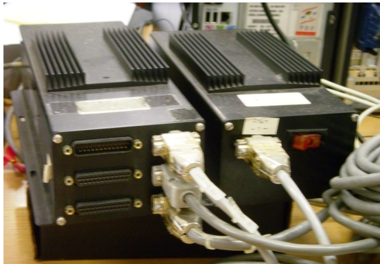
รูปที่ 4.4 เครื่องปรับสภาพสัญญาณจากเครื่องวัดแรง JR3
