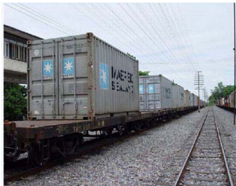
ภาพที่ 2.4 รถโบกี้บรรทุกตู้สินค้า (บทต.)
