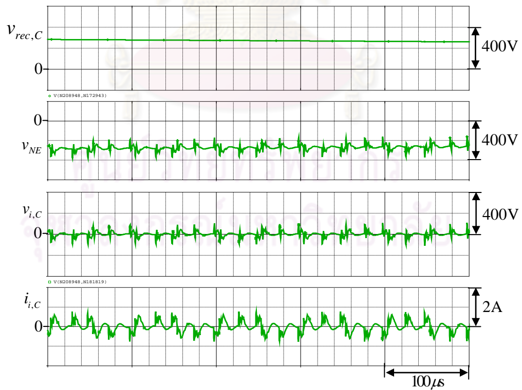
รูปที่ 4.5 ผลจำลองแรงดันและกระแสโหมตรวมที่ด้านหน้าของอินเวอร์เตอร์ในสเกลเวลาของความถี่การสวิตช์ ในช่วงที่วงจรเรียงกระแสทำงานในย่านนำกระแส
