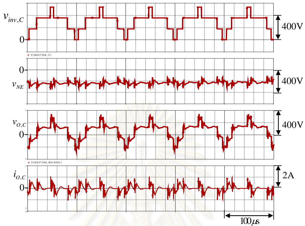
รูปที่ 4.12 ผลจำลองแรงดันและกระแสโหมคร่วมที่ด้านออกของอินเวอร์เตอร์ในสเกลเวลาของความถี่การสวิตช์ ในช่วงที่วงจรเรียงกระแสทำงานในย่านไม่นำกระแส
