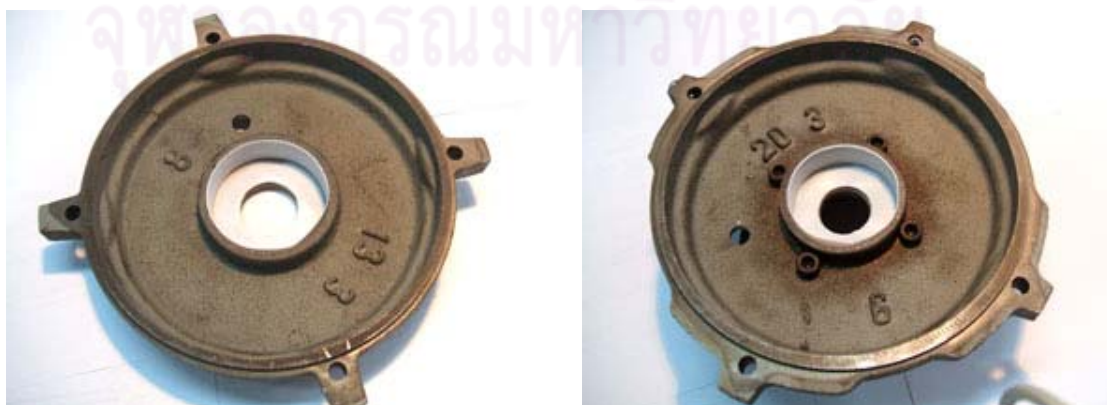
รูปที่ ก.4 ฝาโครงมอเตอร์ทั้งสองด้านเมื่อแทรกฉนวนฟิล์มเทฟลอน
