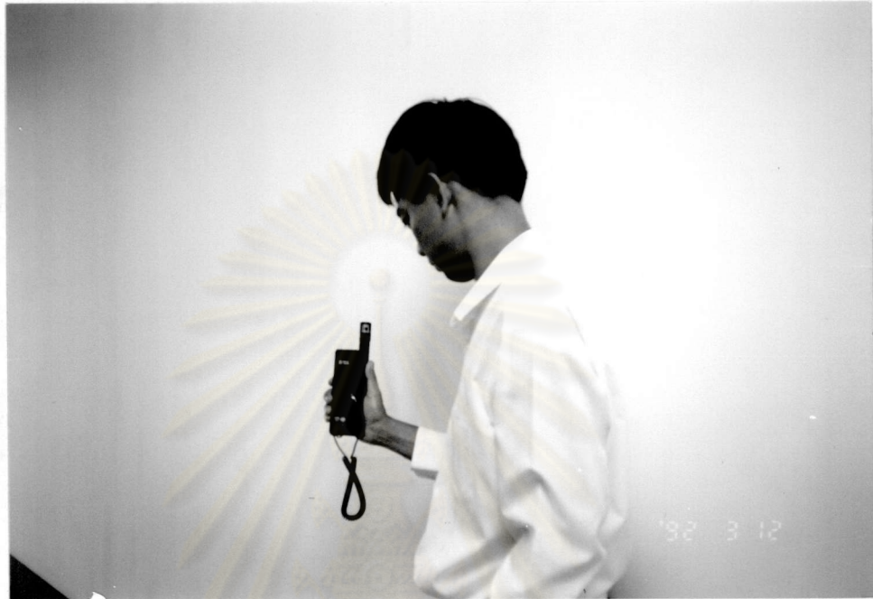
เครื่องวัดความชื้นสัมพัทธ์ของอากาศแบบเชิงเลข
