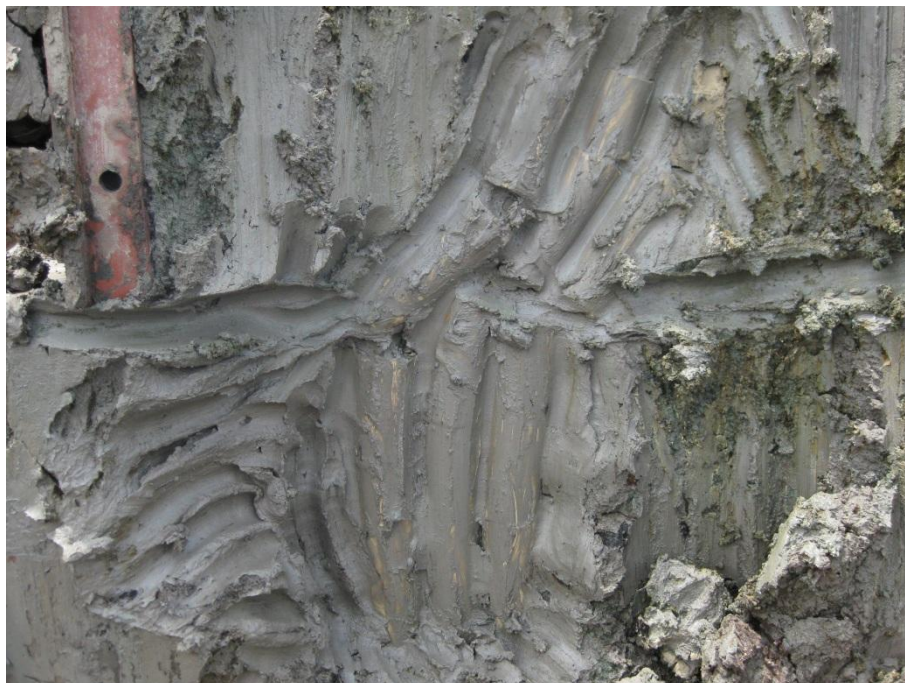
ภาพที่ ค.6 รูปแบบการวิบัติแบบจำลองแท่งดินซีเมนต์รับแรงทางด้านข้าง Case 3-2
