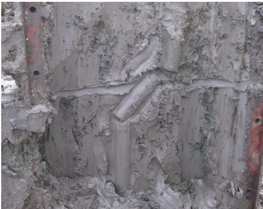
ภาพที่ ค.5 รูปแบบการวิบัติแบบจำลองแท่งดินซีเมนต์รับแรงทางด้านข้าง Case 3-2
