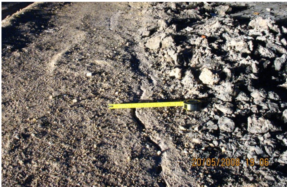
ภาพที่ ก.13 แสดงรอยแยกบริเวณชั้นโคลนของแปลงทดลองที่ 1
