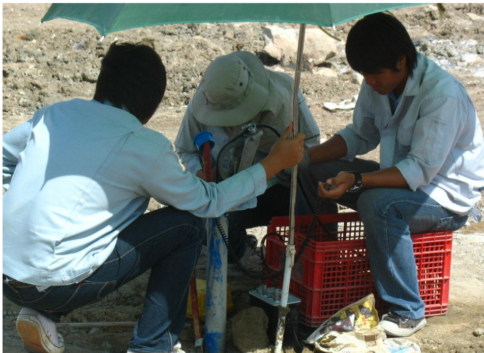
ภาพที่ ก.3 แสดงการตรวจวัดการเคลื่อนตัว
