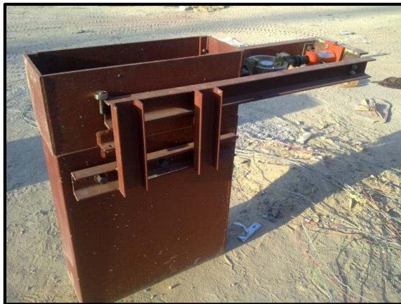
ภาพที่ 3.30 กล่องทดสอบแบบจำลองแท่งดินซีเมนต์รับแรงทางด้านข้าง
