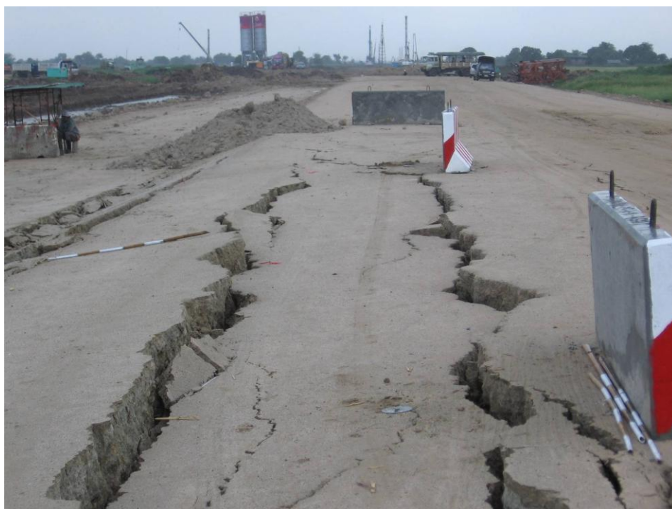
ภาพที่ ก.14 การเคลื่อนตัวของบริเวณชั้นโคลนและถนนของแปลงทดลองที่ 2
