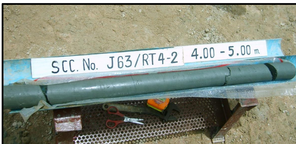
ภาพที่ 3.6 ตัวอย่างเสาเข็มดินซีเมนต์ที่สุ่มเจาะ
