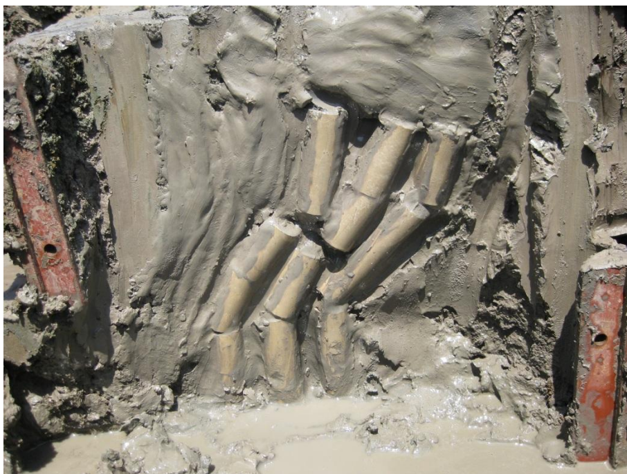
ภาพที่ ค.4 รูปแบบการวิบัติแบบจำลองแท่งดินซีเมนต์รับแรงทางด้านข้าง Case 2-2
