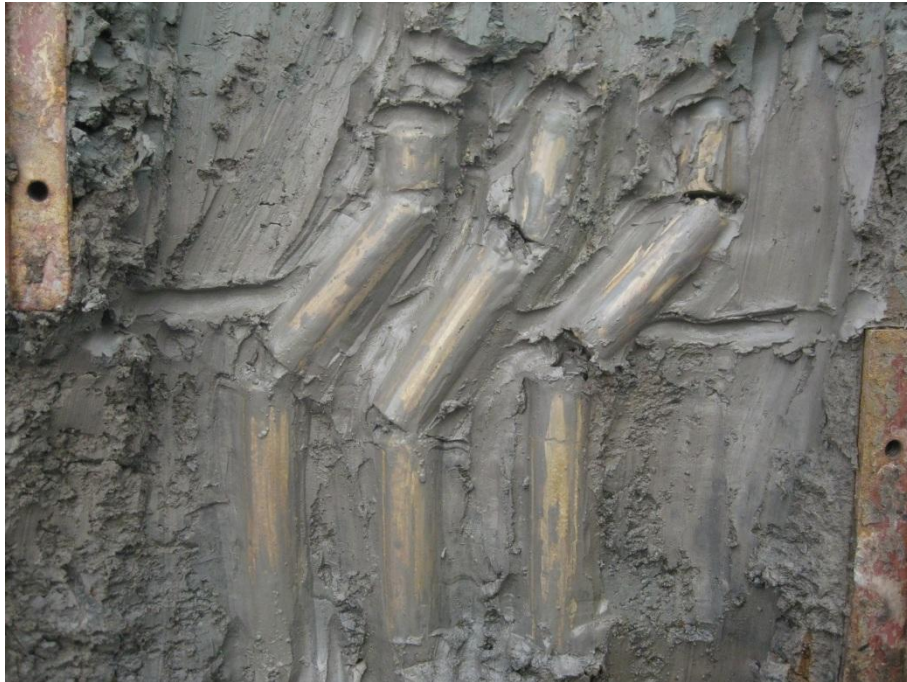
ภาพที่ ค.7 รูปแบบการวิบัติแบบจำลองแท่งดินซีเมนต์รับแรงทางด้านข้าง Case 4-2
