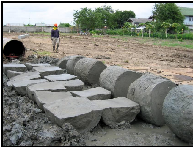
ภาพที่ 3.7 ตัวอย่างเสาเข็มดินซีเมนต์ที่ดึงขึ้นมาทดสอบ
