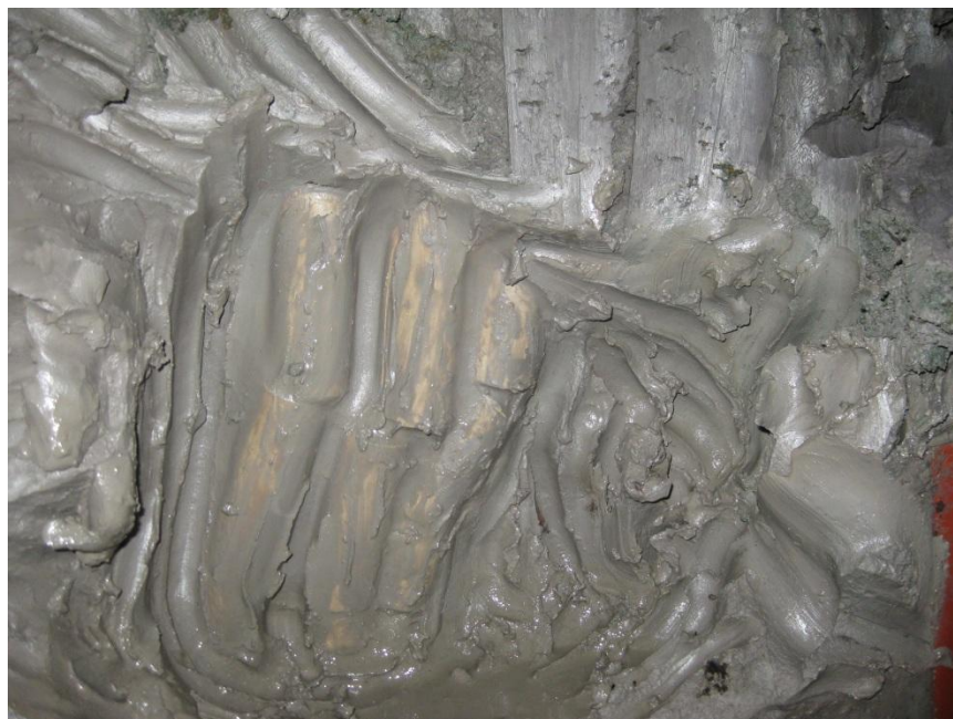
ภาพที่ ค.2 รูปแบบการวิบัติแบบจำลองแท่งดินซีเมนต์รับแรงทางด้านข้าง Case 1-2
