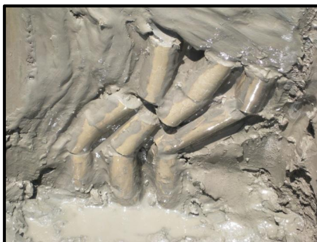
ภาพที่ 4.7 การวิบัติของแท่งดินซีเมนต์ภายหลังการทดสอบ
