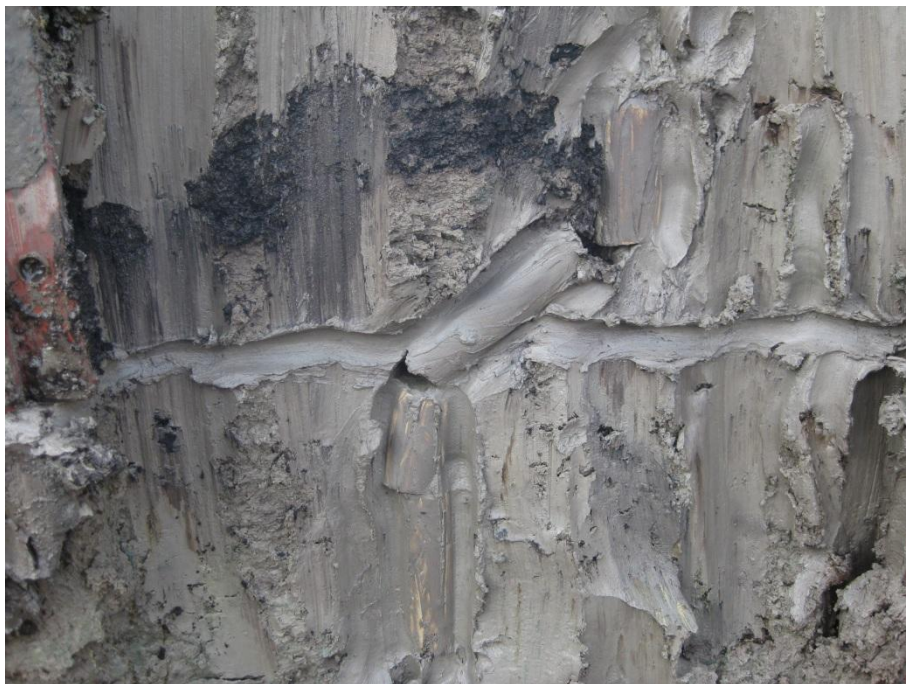
ภาพที่ ค.3 รูปแบบการวิบัติแบบจำลองแท่งดินซีเมนต์รับแรงทางด้านข้าง Case 2-1
