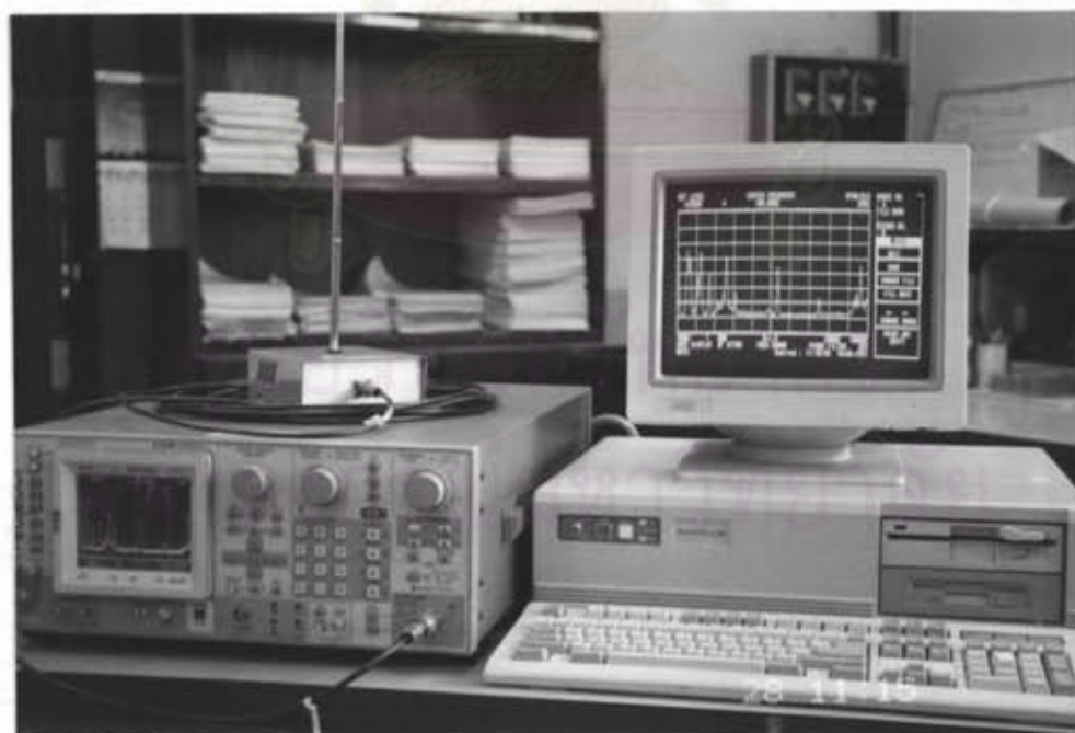
รูปที่ 3.6 ระบบอุปกรณ์ที่จัดตั้งขึ้น ประกอบด้วยเครื่องวิเคราะห์สเปกตรัม สายอากาศ และ เครื่องคอมพิวเตอร์
