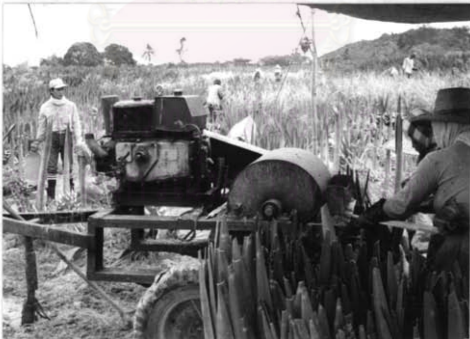
รูปที่ 6 การชูดเส้นใบป่านศรนารายณ์ด้วยเครื่องชูดแบบที่ใช้ไนโร
