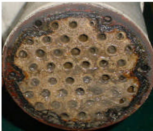
รูปที่ 1.1 การเกิดตะกรันในเครื่องแลกเปลี่ยนความร้อน
