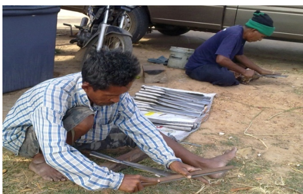
ภาพที่ 12 การขัดผิวซ้ำด้วยตะไบละเอียด
