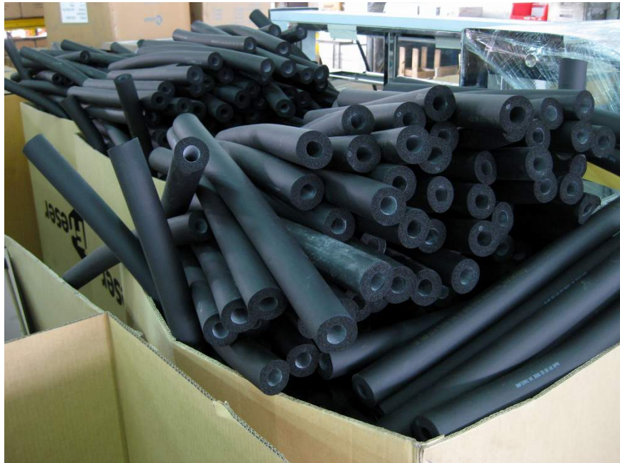
รูปที่ 3.13 ฉนวนหุ้มท่อน้ำร้อน
