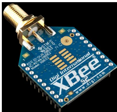
ภาพที่ ข.2 รูปร่างของ Zigbee เบอร์ด XB24-Z7SIT-004 [29]
