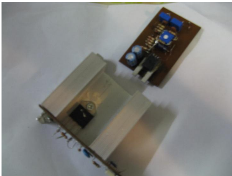
ภาพที่ 5.3 การประกอบวงจรตัดต่อโหลดเข้ากับวงจรวัดกระแสไฟฟ้า
