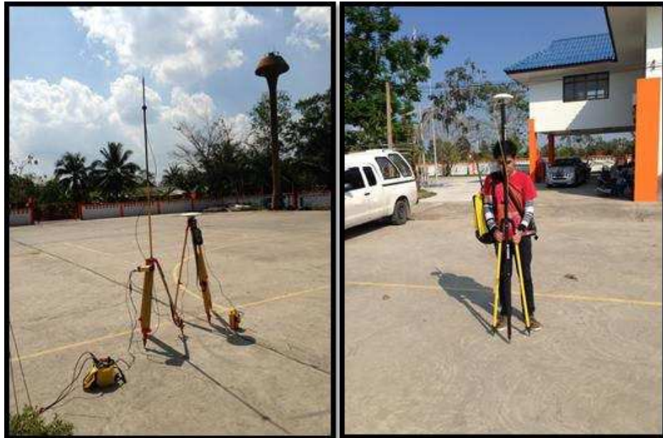
รูปที่ 3.11 การทำ RTK โหมด Stake Out เพื่อหาและกำหนดตำแหน่งจุดตรวจสอบ
