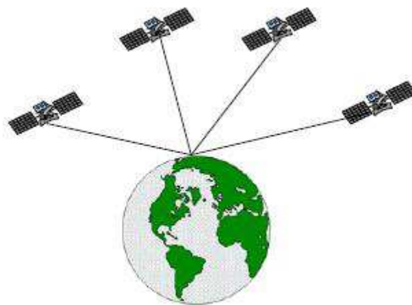
รูปที่ 2.3 การหาตำแหน่งจุดเดียว (เฉลิมชนม์ สติระพจน์, 2552)
