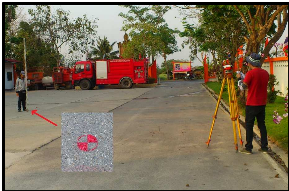
รูปที่ 3.12 การทำระดับภาคพื้นดินด้วยกล้องระดับ เพื่อหาค่าความสูงออร์โทเมตริกของจุดตรวจสอบที่เลือกไว้ทั้ง 32 จุด ที่ทำเครื่องหมายไว้ในพื้นที่
