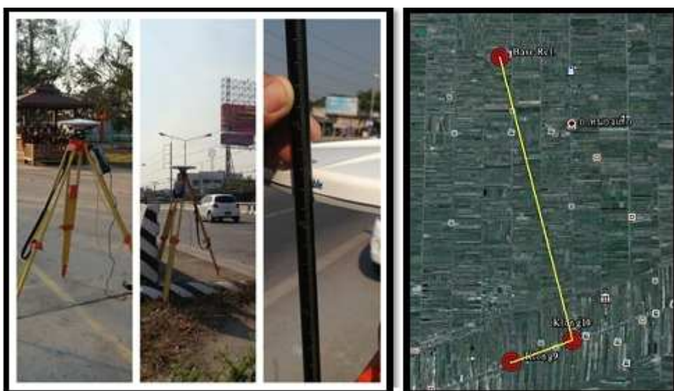
รูปที่ 3.5 การถ่ายระดับด้วยดาวเทียม
