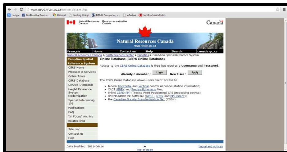
รูปที่ 3.9 การให้บริการประมวลผลข้อมูลรังวัดดาวเทียมในรูปแบบออนไลน์ของ CSRS-PPP
