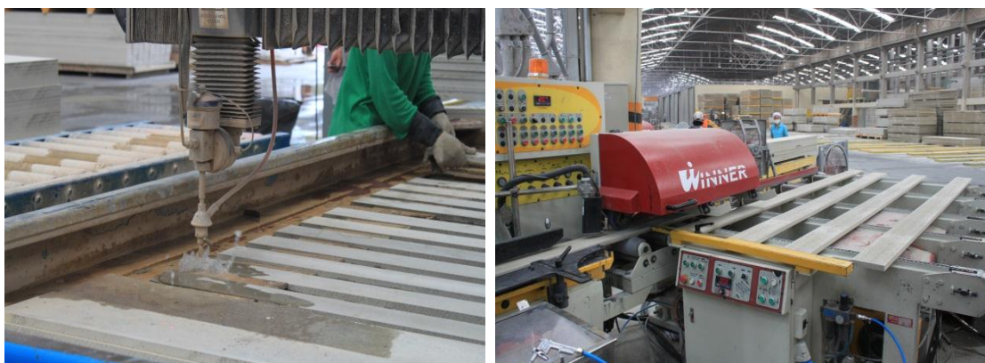
ภาพที่ 3-9 เครื่องตัดแรงดันน้ำ (water jet) ที่มา : ผู้วิจัย,บ.คอนวูด จำกัด,22 สิงหาคม 2555
