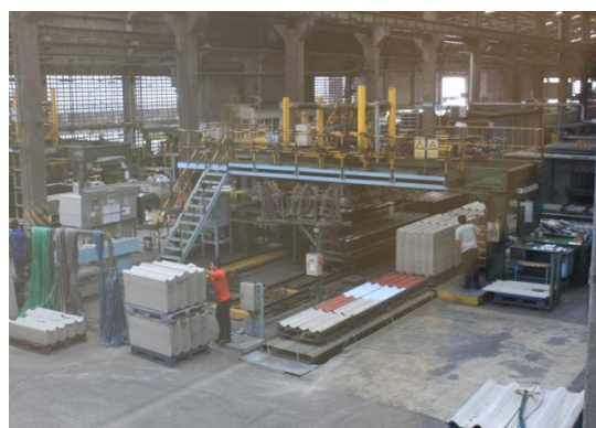
ภาพที่ 3-11 ลูกกลิ้งสำหรับขึ้นรูป ที่มา : ผู้วิจัย,บ. มหพันธ์ไฟเบอร์ซีเมนต์ จำกัด,17 พฤศจิกายน 2555
