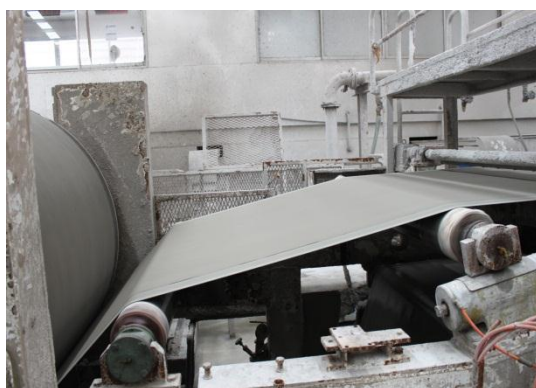
ภาพที่ 3-11 ลูกกลิ้งสำหรับขึ้นรูป ที่มา : ผู้วิจัย,บ. มหพันธ์ไฟเบอร์ซีเมนต์ จำกัด,17 พฤศจิกายน 2555
