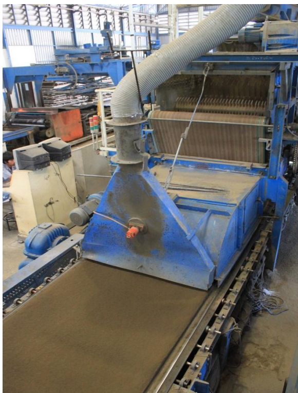
ภาพที่ 3-25 เครื่องโรยส่วนผสม ที่มา : ผู้วิจัย,บริษัท วิบูลย์วัฒนาอุตสาหกรรม จำกัด, 12 กันยายน 2555
