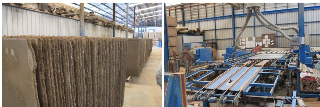
ภาพที่ 3-29 การบ่มและอบไล่ความชื้น ที่มา : ผู้วิจัย,บริษัท วิบูลย์วัฒนอุตสาหกรรม จำกัด, 12 กันยายน 2555
