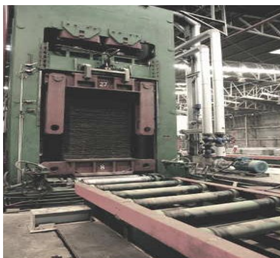
ภาพที่ 3-19 เครื่องอัดแรงดันสูง ที่มา : เอกสารแนะนำบริษัท พาเนล เวิลด์ , หน้า 8
