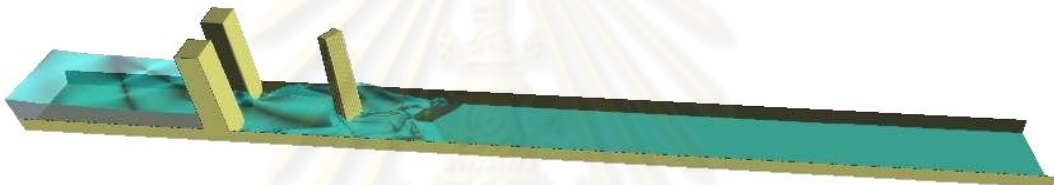
รูปที่ 6.6 ภาพแสดงการจำลองเขื่อนแตกที่ใช้สำหรับการเปรียบเทียบกับผลการทดลอง ณ เวลาที่ t = 3.9 s
