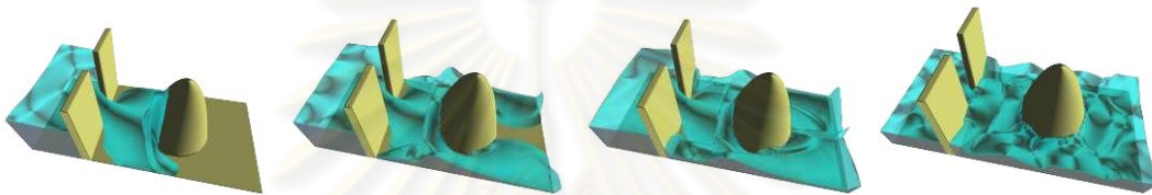
รูปที่ 6.15 ภาพแสดงการจำลองการไหลของน้ำผ่านสิ่งกีดขวางลักษณะนูนสูง
